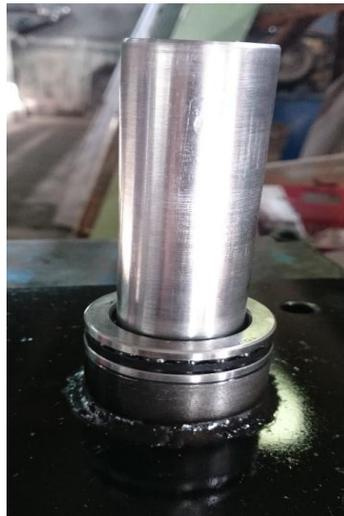
Figura 3.18 - Unión de cilindro junto con rodamiento de carga axial.
