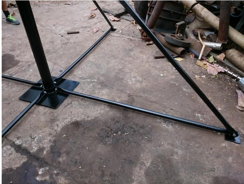
Figura 3.31 - Ensamble final de los soportes horizontales junto a los verticales.
