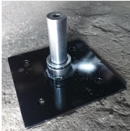
Figura 3.17 - Unión de placa, cilindro y rodamiento de carga axial.
