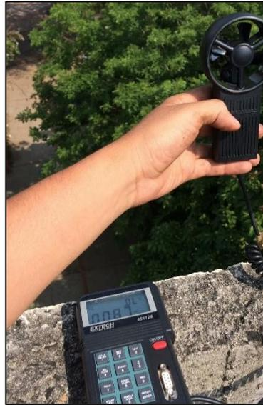
Figura 4.1 - Anemómetro utilizado.
