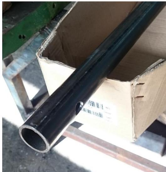
Figura 3.15 - Agujero para colocación de perno de estructura de veleta.
