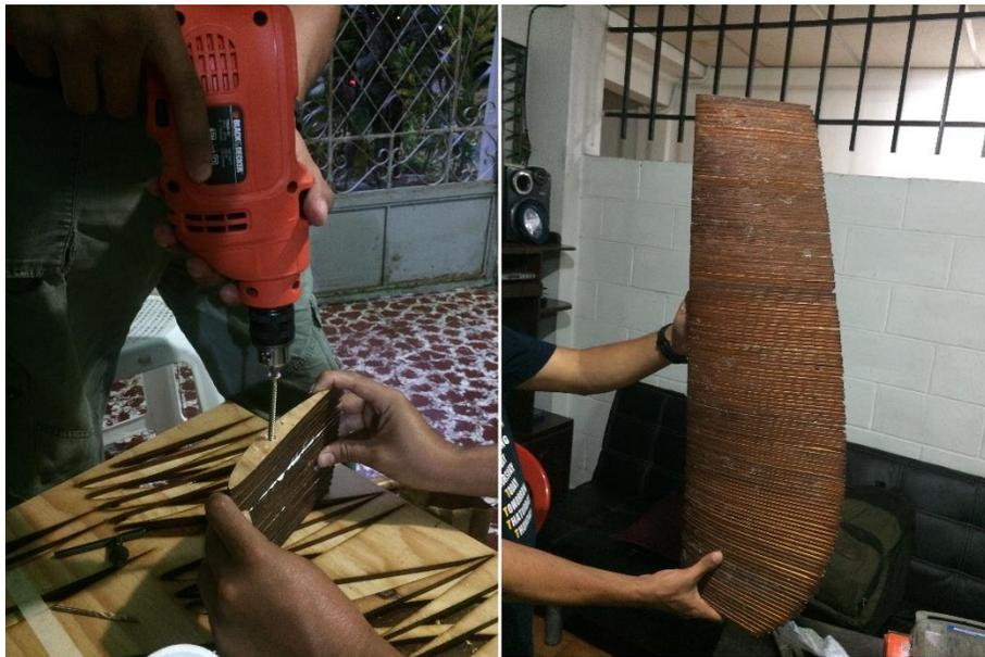
Figura 3.3 - Unión de secciones de perfiles hasta formar la hélice completa.
