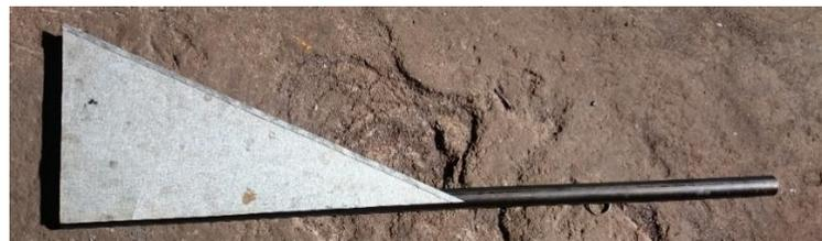
Figura 3.13 - Estructura unificada junto con veleta.
