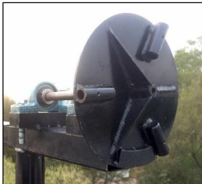
Figura 3.6 - Plato o cubo donde conectan las hélices.
