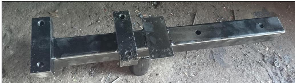
Figura 3.7 - Base principal con todos sus elementos soldados.
