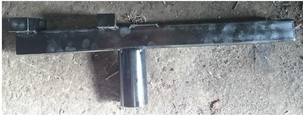
Figura 3.20 - Unión de cilindro giratorio a la base principal usando soldadura.
