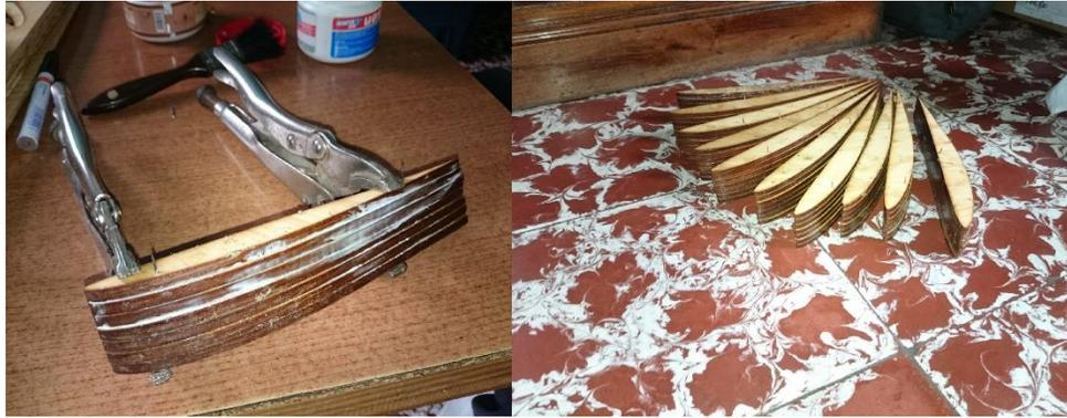
Figura 3.2 - Secciones de perfil unidos para dar el alabeo característico de la hélice.
