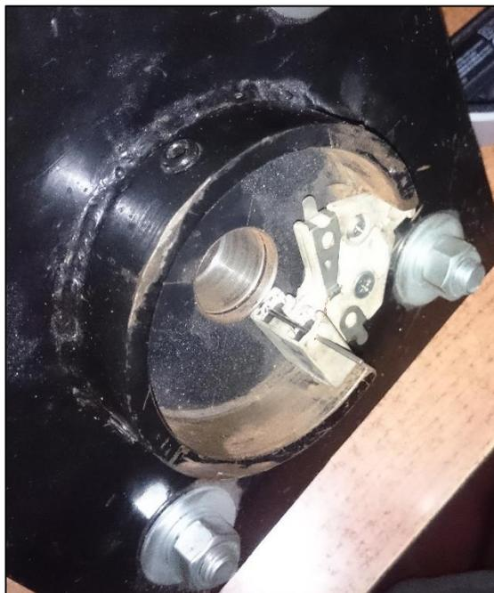
Figura 3.22 - Carbones o escobillas para el colector.
