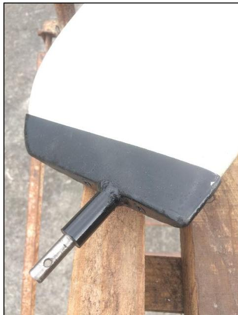
Figura 3.5 - Conector de la hélice con cobertor.
