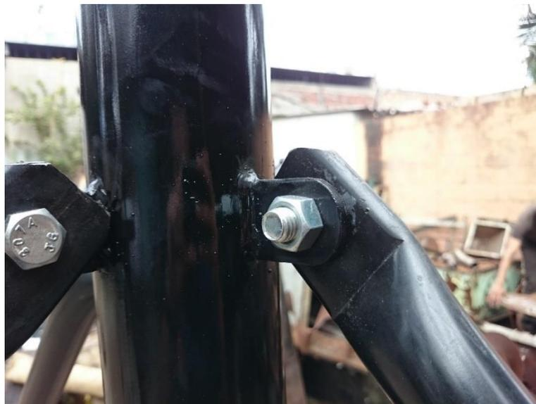
Figura 3.26 - Unión de soportes a las argollas superiores.
