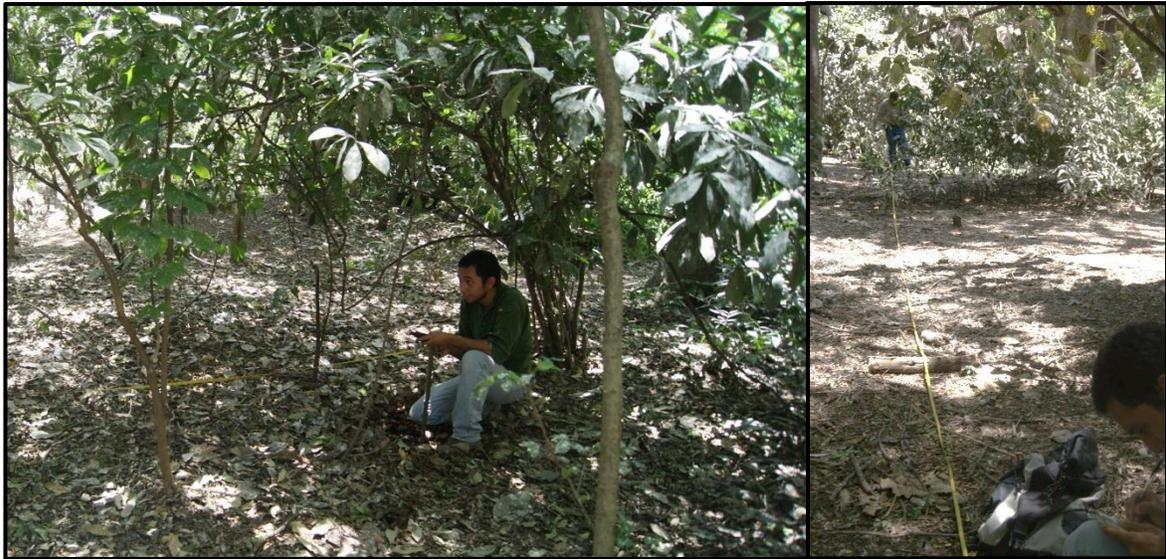
**Imagen 7:** Establecimiento de parcela de 15x15 metros utilizando estacas, cinta métrica de 50 metros y brújula (Garmin GPSmap 62). Sector La Barra, junio del 2015.
