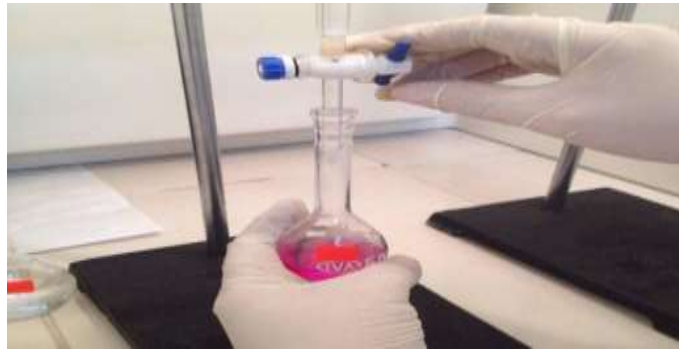
Figura N° 26 Incorporación de los reactivos Diclorhidrato de N-1 naftiletildiamina y Sulfanilamida
