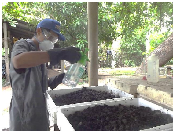
Figura 6. Aplicación de productos a los lodos con asperjadora manual.
