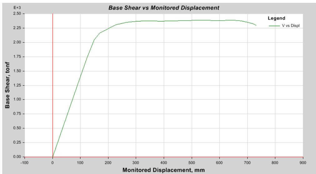
Fig. 4.16 Curva de capacidad, carga lateral modal, diseño original, dir. X - X
