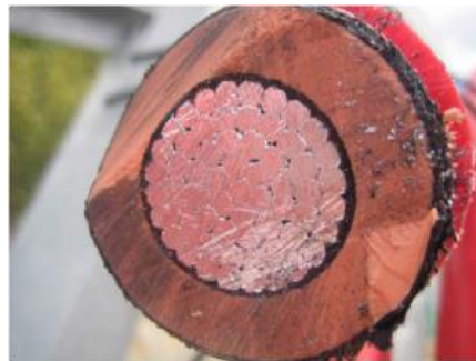
Fig. 15 “Este efecto es apreciable en conductores de sección grande”
