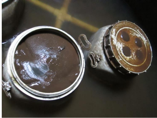
Figura 32. Filtro de esponja reteniendo partículas de hierro y manganeso.
