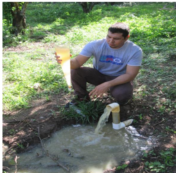
Figura 25. Toma de muestra con Cono Imhoff en tubería de lavado de filtro.
