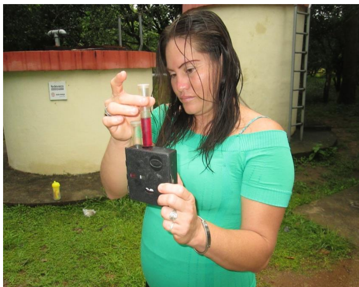
Figura 20. Fontanera monitoreando cloro residual en el agua del sistema.
