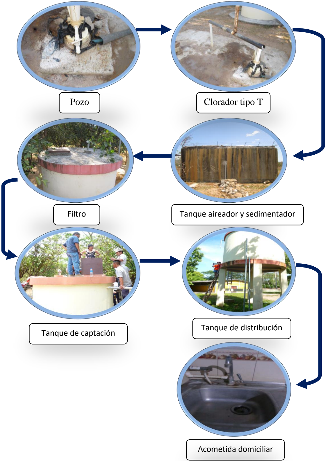
Figura 37. Componentes del sistema de agua.
