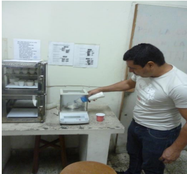
Figura 18. Pesado de dosis de hipoclorito de calcio al 70% en balanza
