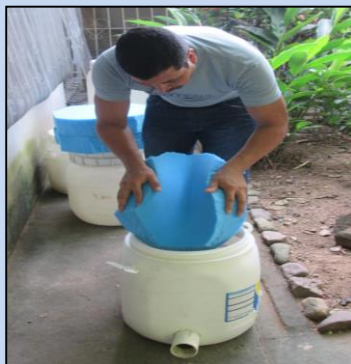
Instalación de esponjas
