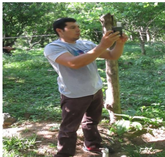
Figura 21. Monitoreando cloro residual antes del filtro lento de arena.
