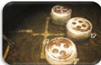
Retención de hierro y manganeso en el filtro de esponja
