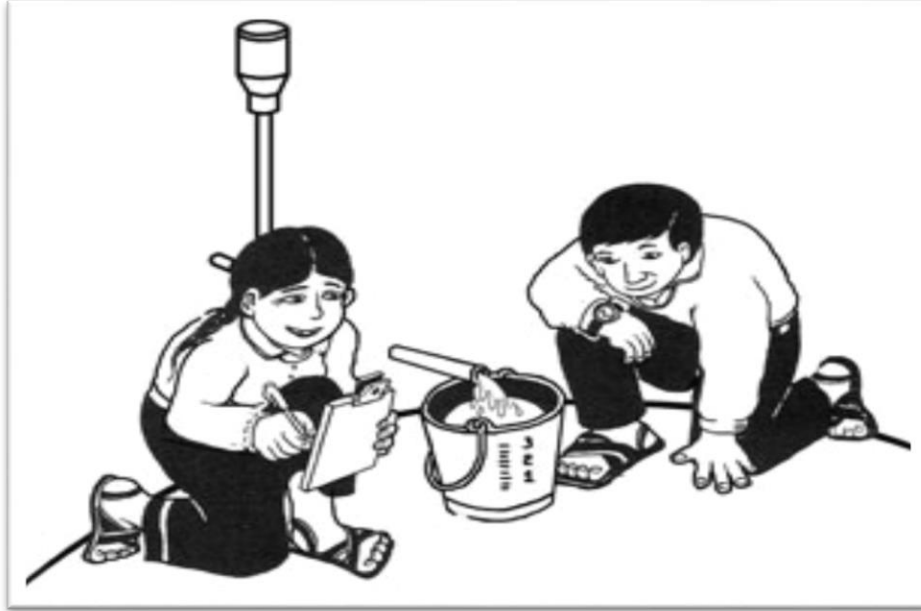
Figura 8. Aforo por método volumétrico.
