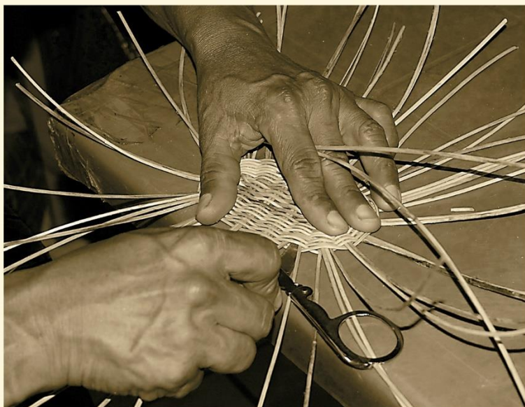
Paso 4: Se agrega hebras a la base para realizar las paredes y dar fijesa.
