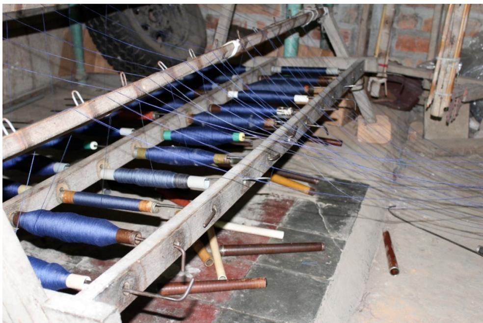
Imagen 8: En la mayoría de casos se usa la trascañadera para direccionar los hilos de forma ordenada hacia el urdidor. Sin embargo, hay ocasiones en que el hilo tiene el suficiente peso y tamaño como para ser tomado directamente desde el cono original puesto en el suelo. Fotografía: Taller Artesanías “El Portalito”
