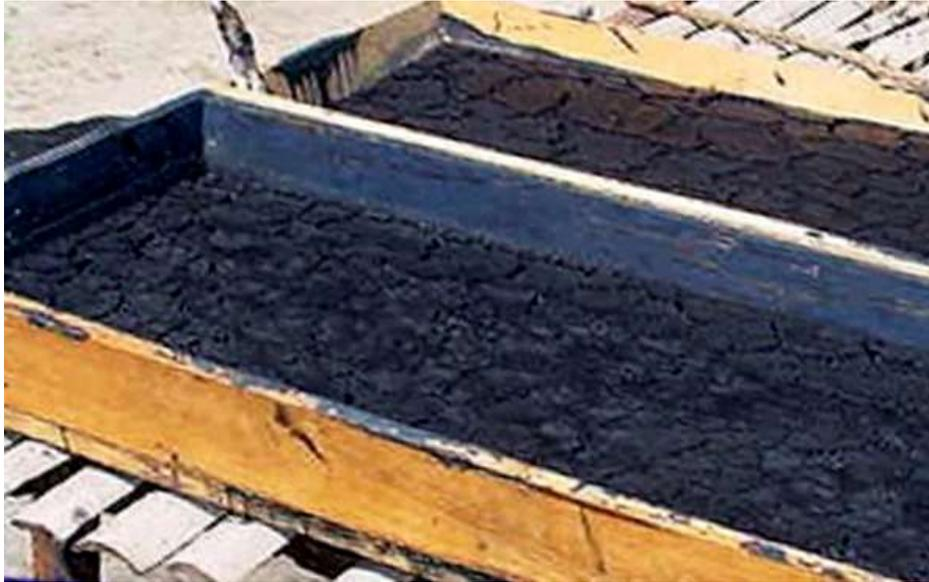
*Figura 10: Bandejas de madera preparando el secado completo del añil.*
