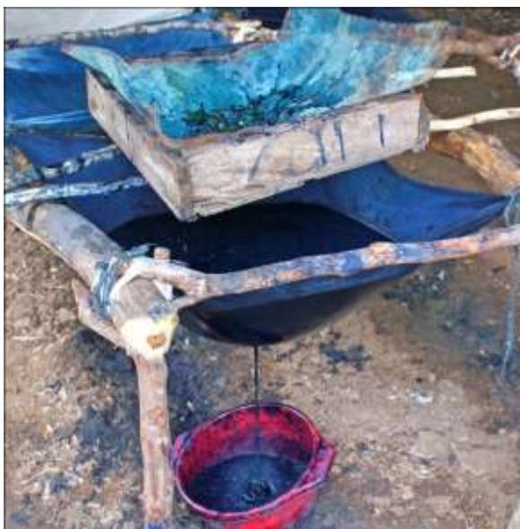
*Figura 8: Proceso de filtrado. El cubo se vacía a través de una malla de alambre en la tela filtrante.*
