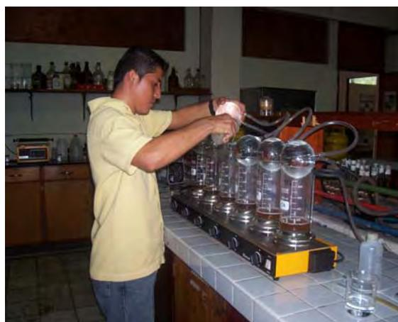
**Figuras 15 y 16: Determinación de fibra ácido y neutro detergente.**
