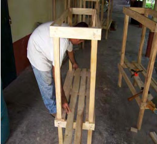
**Figura 8: Fabricación de las jaulas.**
