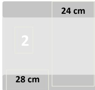
Se cortan dos piezas de plástico. Ambas formaran la bolsa, la parte delantera (1) y la parte trasera (2). La medidas de las solapas (en las imágenes de color gris oscuro), son: 8.5 cm, las cuales compondrán los laterales de la bolsa.
