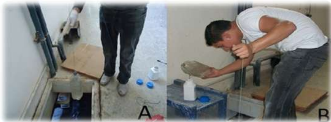
Ilustración 8: A) Elevador de muestra elaborado a partir de una botella pet. B) Toma de muestras subterráneas con el elevador de muestra.
