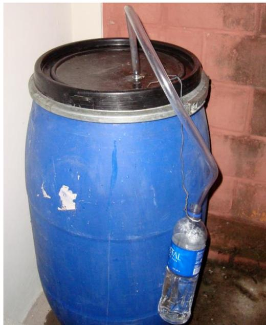
Fig. 20: Barril con tapadera y cincha metálica conectado mediante una manguera a una botella plástica de 350 ml para permitir la fermentación anaeróbica.
