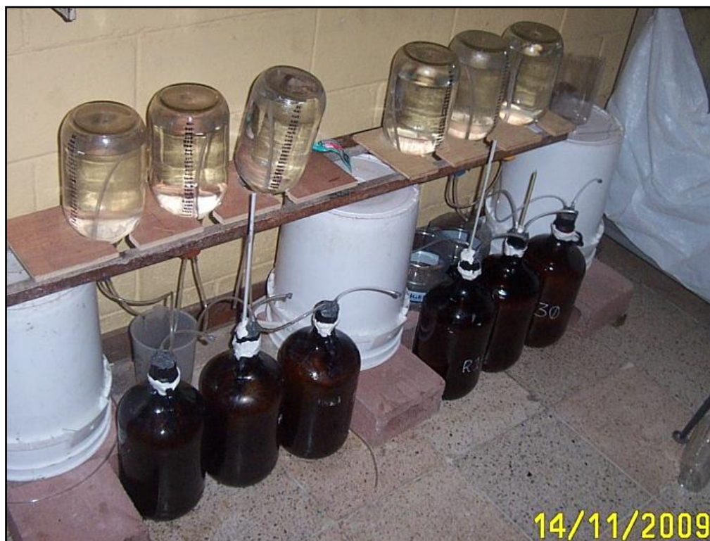
Figura 13.1. Biodigestores para la producción de biogás y biofertilizante, contruidos a partir de materiales reciclados
