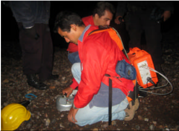
Medición de gases en el contorno del cráter del volcán de Santa Ana, utilizando un sistema de flujo doble
