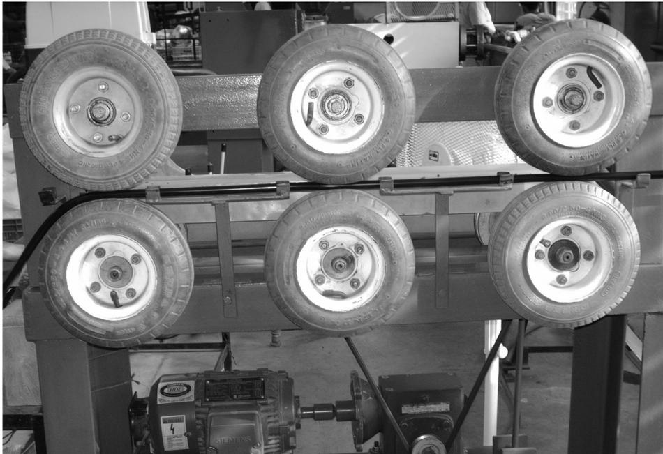
Foto # 2 Específicamente la parte donde a través del rodamiento la manguera se termina de formar.
