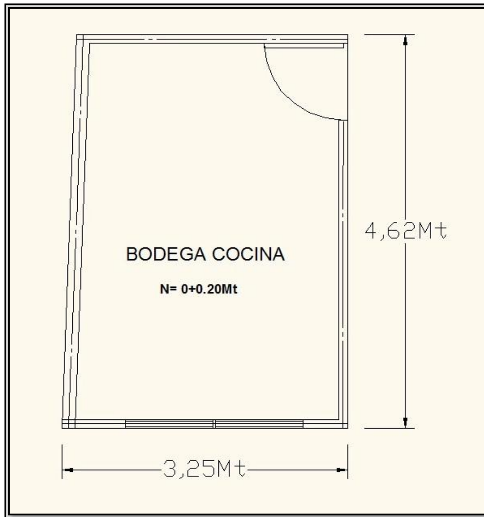
Figura No. 22 detalles de área de bodega de cocina
