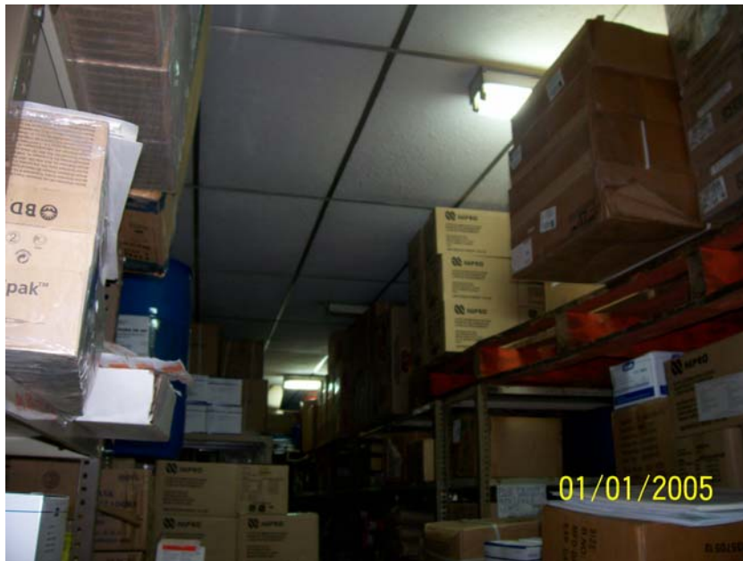
FOTO 59: MATERIALES APILADOS HASTA EL TECHO EN ALMACEN.
