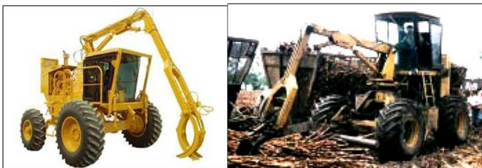
**Ilustración No.2. 21 Cargadora de caña de azúcar**
