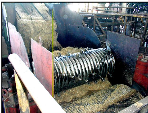
**Ilustración No.2. 3 Fase de Molienda (extracción del jugo) de la caña en los molinos.**
