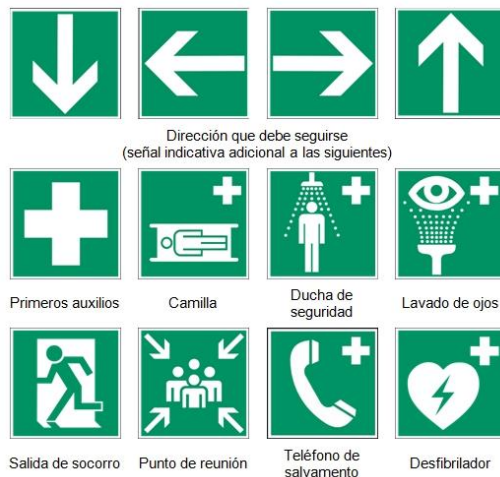
Ilustración 36. Señalización de salvamento
