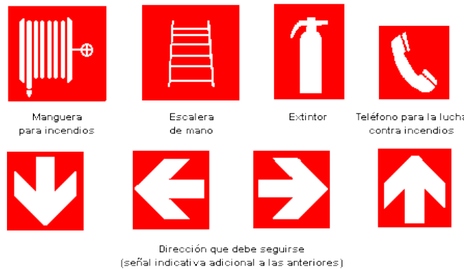
Ilustración 35. Señalización de incendio
