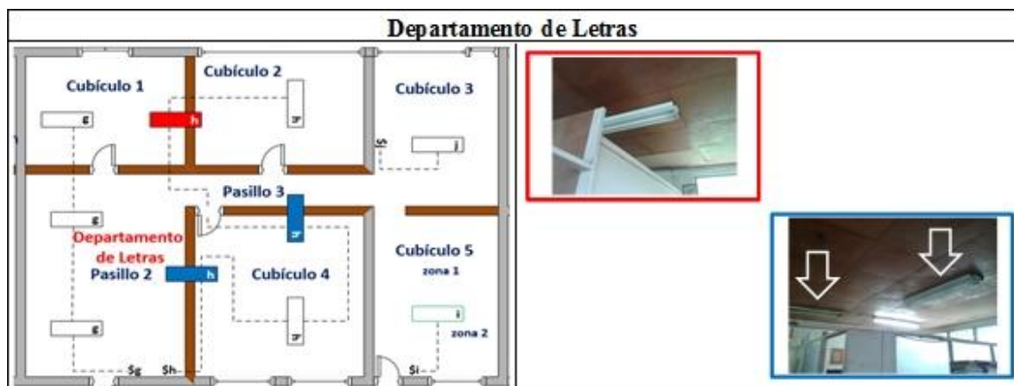
Figura 3.59. Problemas de ubicación: Luminarias en el depto. de Letras sobre paredes divisorias. Nota: Los problemas son en Cubículo 1 a color rojo, cubículo 4 y pasillo 3 a color azul. Fuente Propia.
