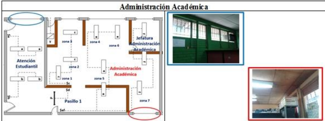
Figura 3.60. Problema iluminación natural: Ventanas pintadas en Admón. Académica. Fuente propia
