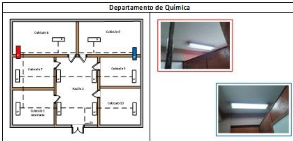
Figura 3.64. Problema de ubicación: Luminarias en el depto. de Química sobre pared divisoria. Fuente: Propia.
