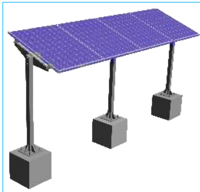
Gráfico 4.6- 4: Estructura de soporte para paneles solares FV.
