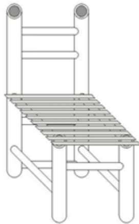
Figura: 110 Colocación de tablillas
