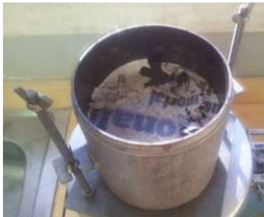
Figura 5. 6 Molde con espécimen para CBR ya compactado, previo a su Saturación. Fuente: Propia.
