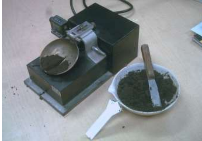
Figura 5. 3 Copa de Casagrande, Ranurador de Muestra y Muestra Ranurada. Fuente: Propia.
