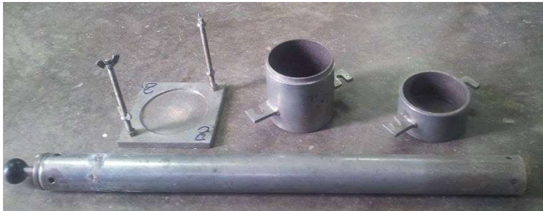
Figura 5. 5 Izquierda a Derecha: Base, Molde Proctor, Collarín y Martillo de 4.54 kg. Fuente: Propia
