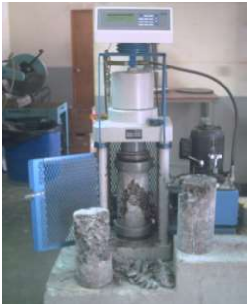
Figura 5. 20 Maquina de Ensayo a Compresión y Espécimen Ensayados. Fuente: Propia.
