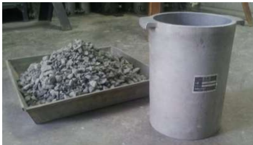
Figura 5. 11 Recipiente para la Prueba de Peso Volumétrico y Muestra de Ensayo. Fuente: Propia.
