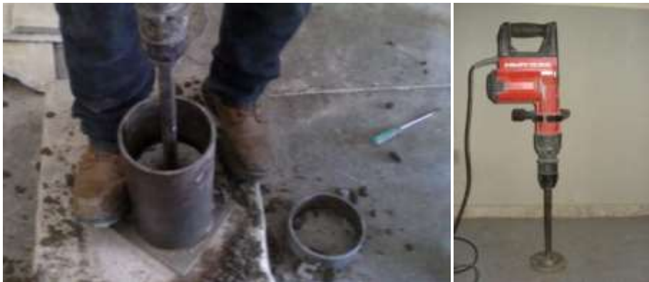
Figura 5. 19 Elaboración de Cilindros de CCR y Rotomartillo (HILTI TE-804). Fuente: Propia.
