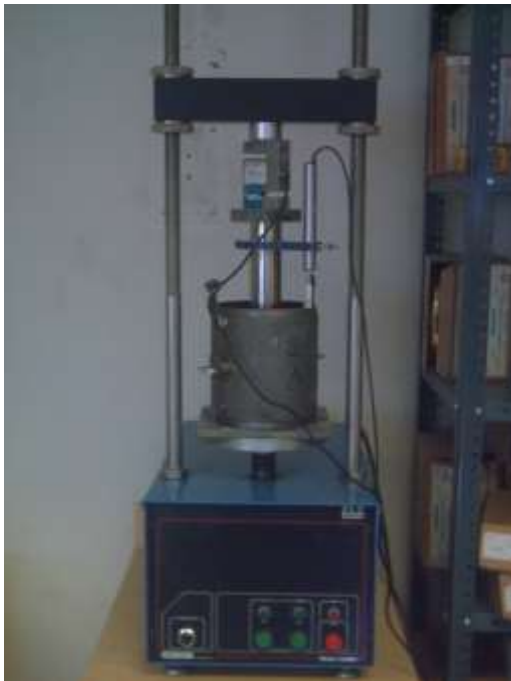
Figura 5. 8 Maquina de Penetración de CBR y espécimen en ensayo. Fuente: Propia.
