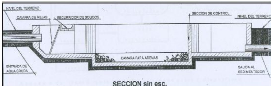
Ilustración 18. Vista lateral de Desarenador
