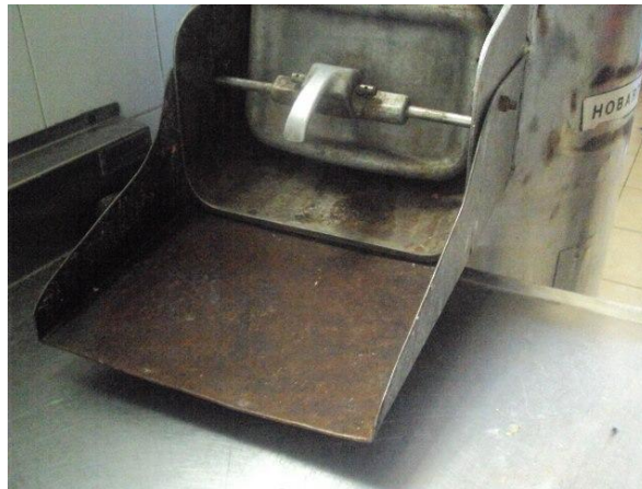
Presencia óxido en el pelador de papas
