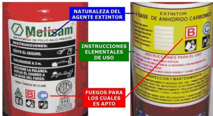
Figura 7 Etiqueta de identificación del extintor
