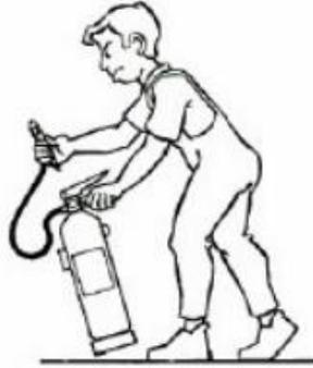
Figura 9 Asir la manguera por la boquilla
