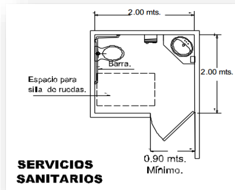
Imagen No. 11. Vista en Planta de Servicios Sanitarios
