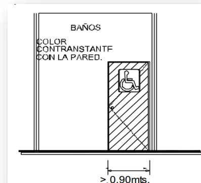
Imagen No. 12. Detalle de puerta de Servicios sanitarios
