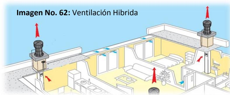
Consiste en crear una depresión artificial en las estancias mediante unos ventiladores de extracción de aire situados en los locales húmedos (cocinas y baños). El aire se introduce por las aberturas “pasivas” en las fachadas o a través de la carpintería, dejando una pequeña abertura para la microventilación.
