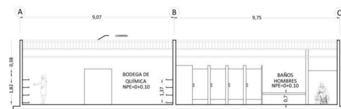
SECCION LONGITUDINAL DE BAÑOS Y BODEGA DE QUÍMICA PROYECCION VISUAL ESCALA 1:150
