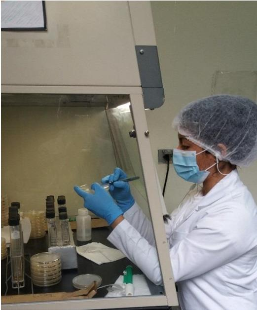
**Figura N° 22.** Preparación de placas con PDA en cabina de flujo laminar
