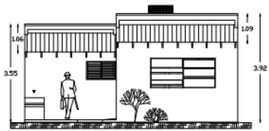
ELEVACION POSTERIOR DE VIVIENDA TIPO ESCALA 1:75
