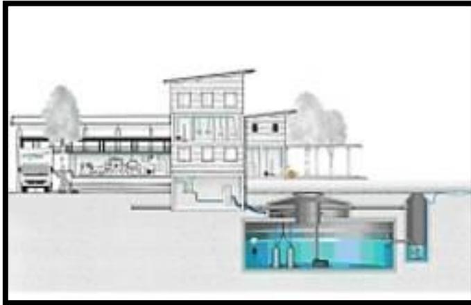
Figura 27. Contenedor soterrado de aguas pluviales
