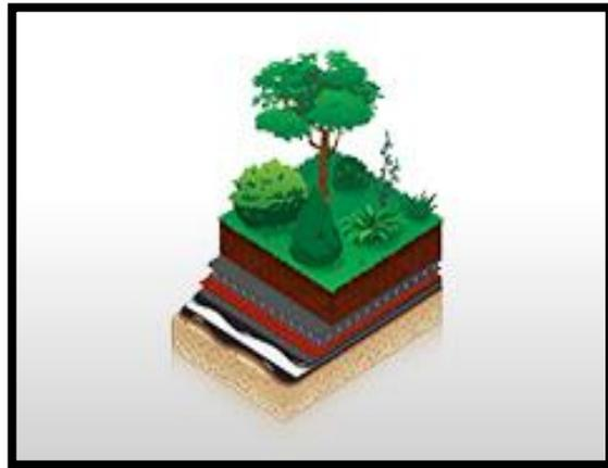
Figura 38. Pintura top Garden impermeable
