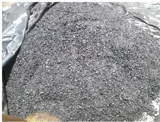
Figura 19. Mezcla asfáltica de planta.
