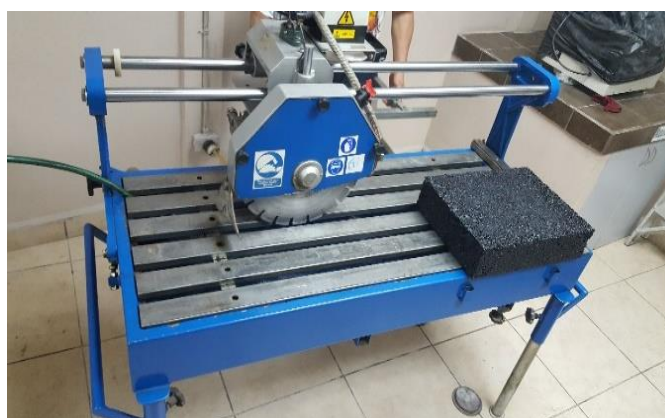
Figura 24. Cortadora de disco con punta acerada, utilizada para cortar placas de mezcla asfáltica compactadas.
