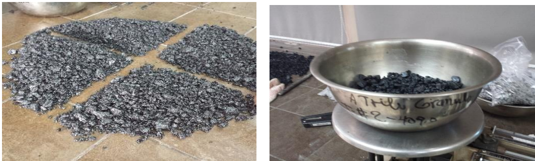
Figura 20. Cuarteo de la mezcla asfáltica y peso de 2500 gramos para realizar el ensayo de teórica máxima.
