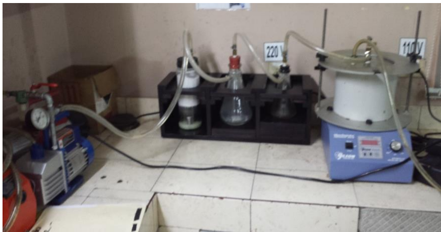
Figura 21. Realización del ensayo teórica máxima.
