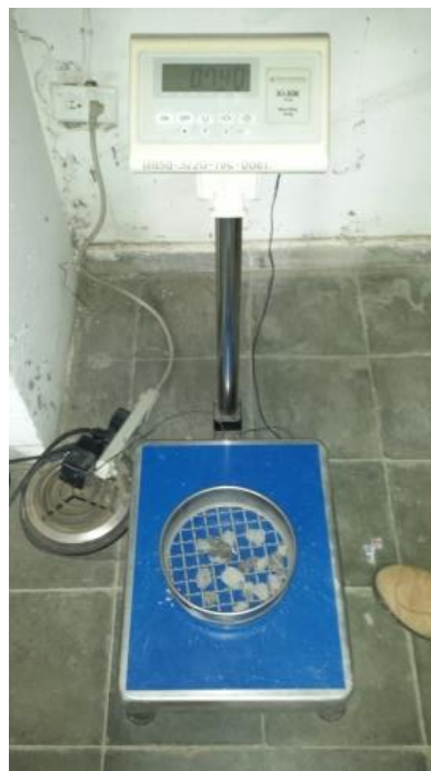
Figura 4-3 Pesaje de agregado grueso contenido en cada malla
