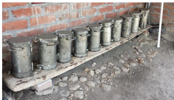
Figura 4-18 Almacenamiento de cilindros de concreto en el molde.
