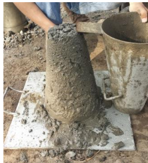
Figura 4-19 Prueba de revenimiento con poca fluidez del concreto
