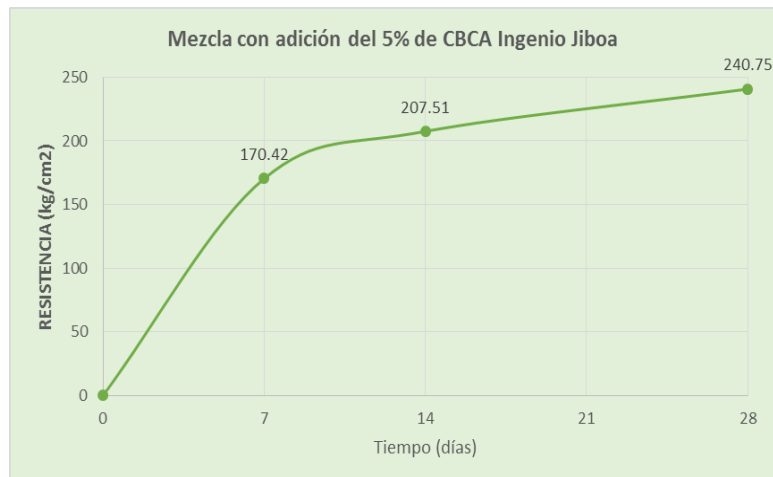
Curva de la resistencia del concreto con el tiempo
