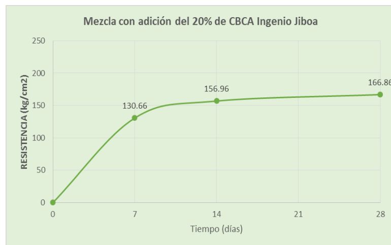
Curva de la resistencia del concreto con el tiempo
