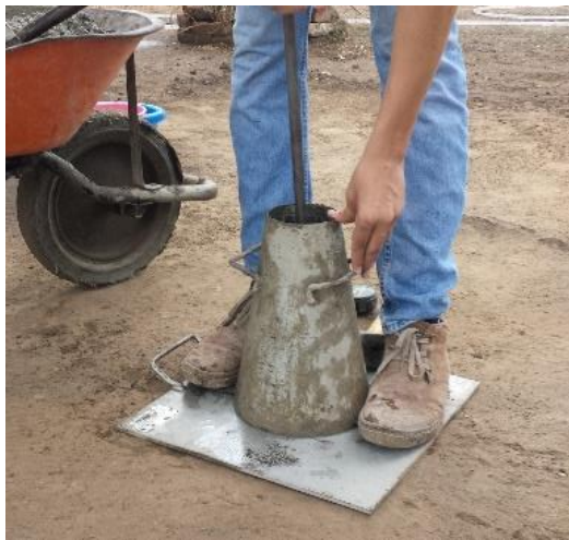
Figura 4-12 Prueba de revenimiento, varillado
