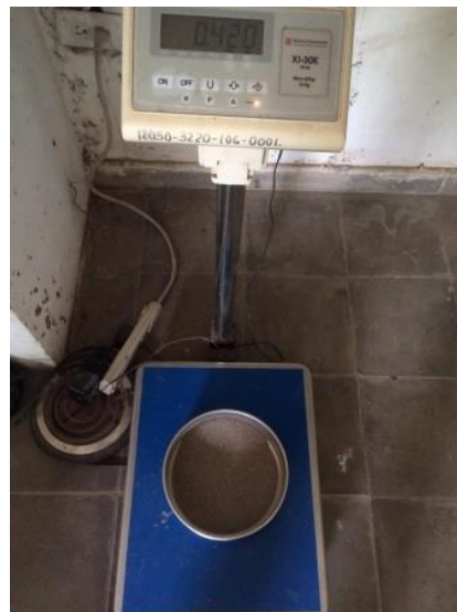
Figura 4-2 Pesaje de agregado fino contenido en cada malla
