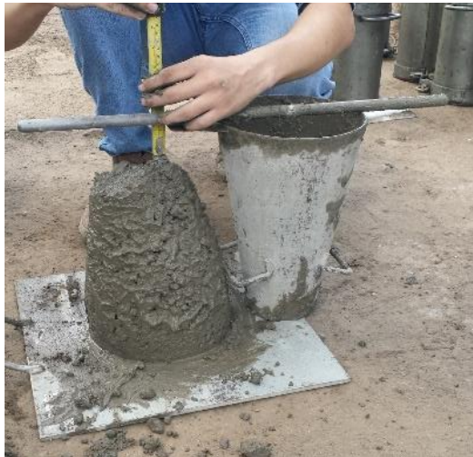
Figura 4-15 Prueba de revenimiento, medición de revenimiento.
