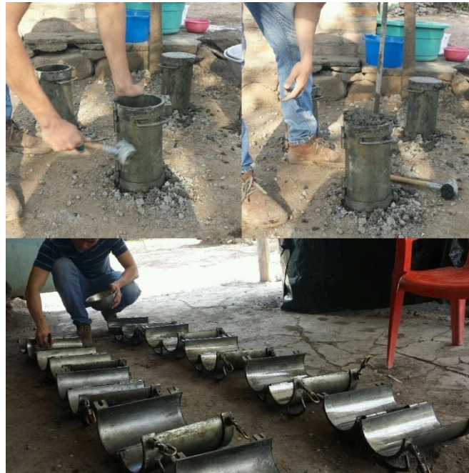
Figura 4-17 Golpeo y varillado al concreto en el molde y engrasado de moldes.
