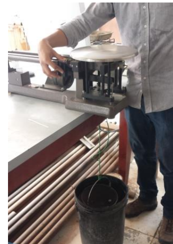
Figura 4-5 Obteniendo el peso sumergido del agregado
