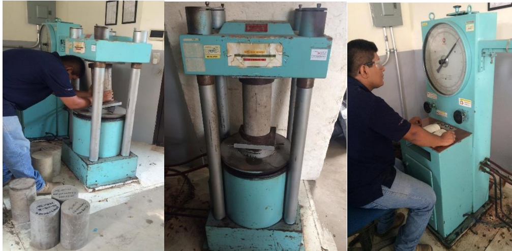
Figura 4-20 Compresión de cilindros de concreto
