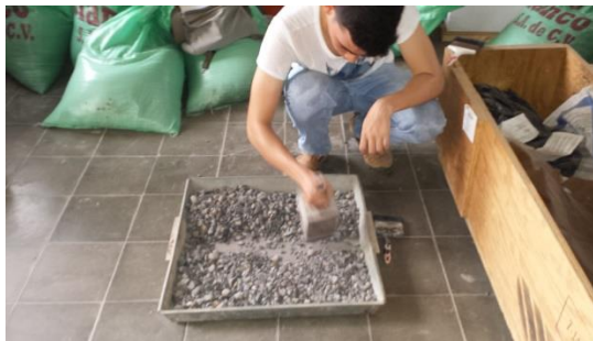
Figura 4-4 Cuarteo del material grueso antes del ensayo
