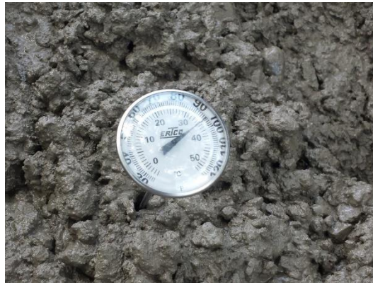
Figura 4-16 Temperatura de concreto.
