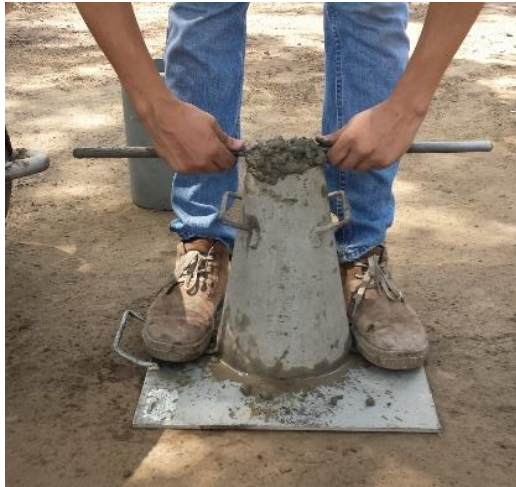
Figura 4-13 Prueba de revenimiento, alisando superficie de concreto
