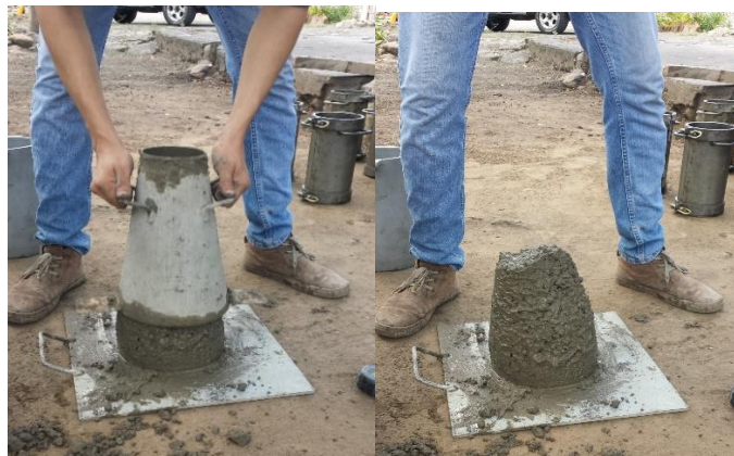
Figura 4-14 Prueba de revenimiento, retirando el molde
