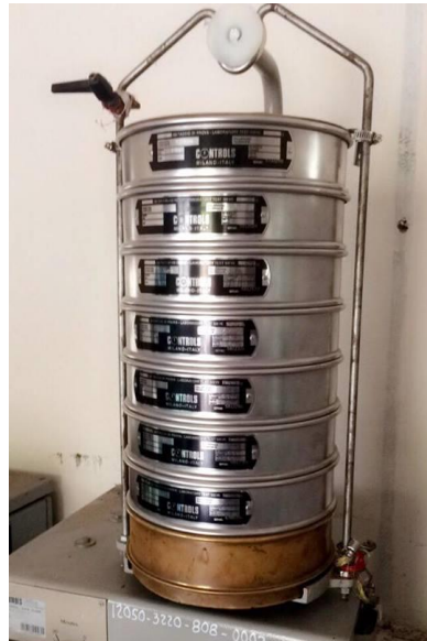
Figura 4-1 Vibrado de los tamices en el RO-TAP
