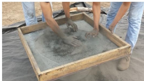
Figura 4-8 Tamizado de la ceniza por la malla zaranda
