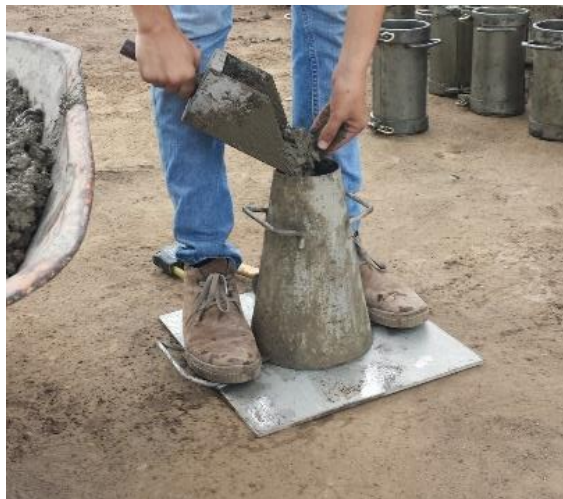
Figura 4-11 Prueba de revenimiento, llenado de capas
