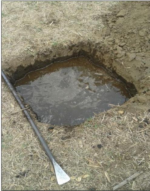
**Figura 5.1.** Prueba de infiltración en campo
