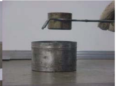
Figura 5.13 Colocación del Cemento Asfáltico en recipiente con agua
