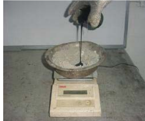
Figura 5.51 Adición del C.A. a los agregados
