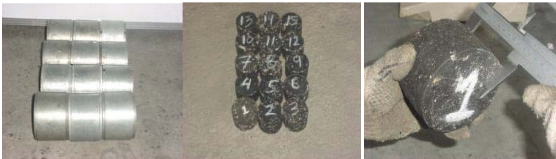
Figura 5.58 Briquetas en reposo en los moldes Figura 5.59 Identificación de briquetas Figura 5.60 Medición de las briquetas
