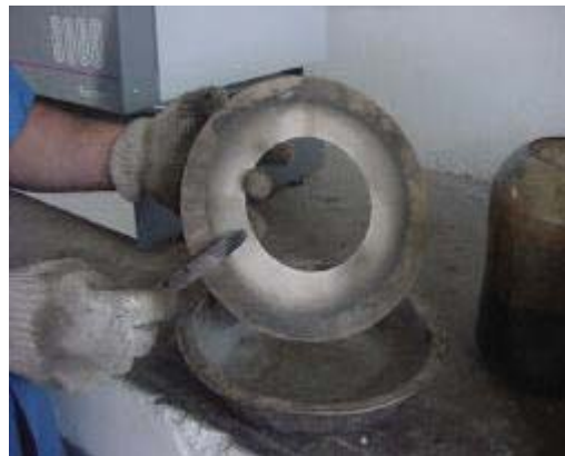
Figura 5.41 Limpieza del filtro
