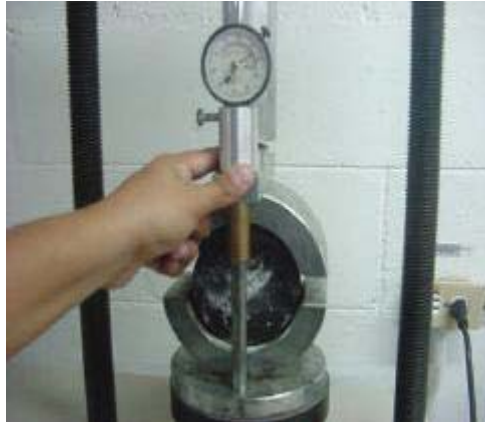
Figura 5.67 Sujeción del medidor de deformación
