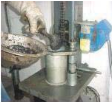
Figura 5.55 Colocación de la mezcla dentro del molde Marshall
