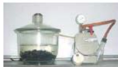
Figura 5.79 Extracción de los vacíos de la mezcla
