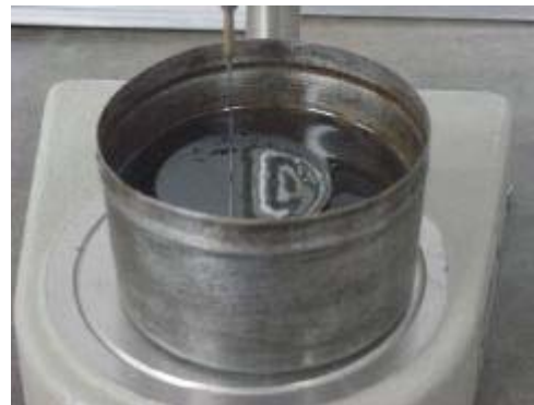
Figura 5.14 d. Contacto de la aguja del penetrómetro con la superficie del Cemento Asfáltico
