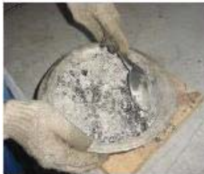
Figura 5.52 Mezcla de los agregados y C.A.
