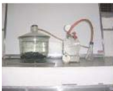
Figura 5.80 Extracción de los vacíos de la mezcla
