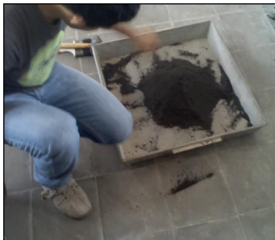
Imagen 3.5: Cuarteo Manual de Agregado Fino
