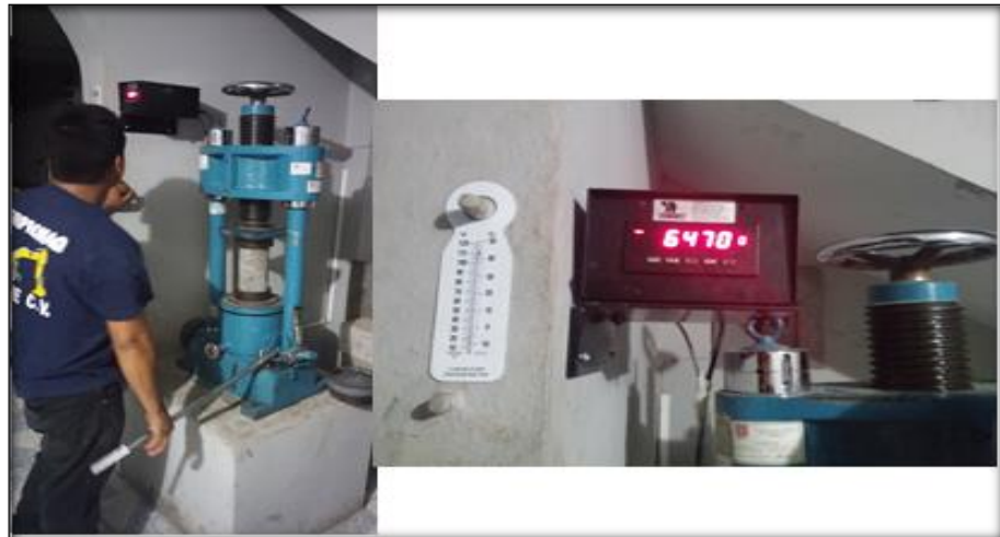
Imagen 3.22: Prueba de compresión Fuente: Grupo de Tesis
