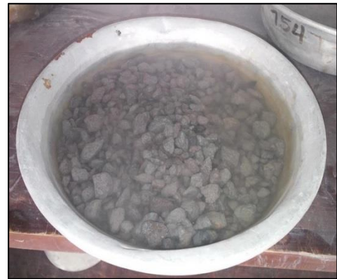
Imagen 3.7 Agregado Grueso sumergido en Agua Fuente: Grupo de Tesis
