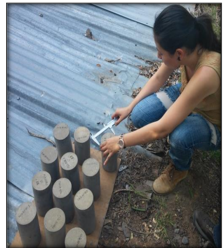
Imagen 3.20: Medición de diámetro Fuente: Grupo de Tesis
