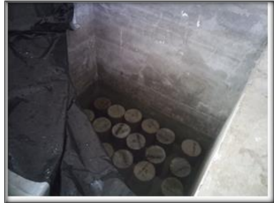
Imagen 3.19: Cilindros en solución de sulfato de Mg
