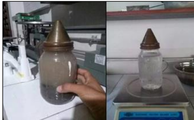
Imagen 310: Prueba con picnómetro Fuente: Grupo de Tesis
