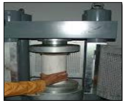
Figura 2.10: Ensayos de Resistencia a la Compresión Fuente: Libro Diseño y control de Mezclas de Concreto
