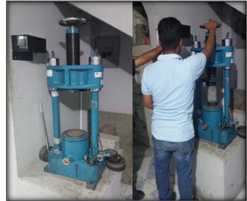
Imagen 3.21: Prueba de compresión Fuente: Grupo de Tesis
