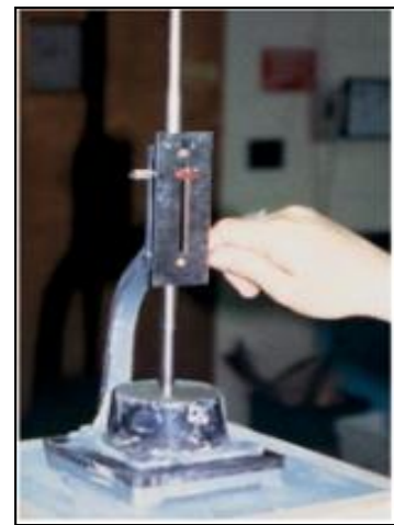
Figura 2.8: Ensayos de consistencia normal para pastas usando aguja de Vicat Fuente: Libro Diseño y control de Mezclas de Concreto
