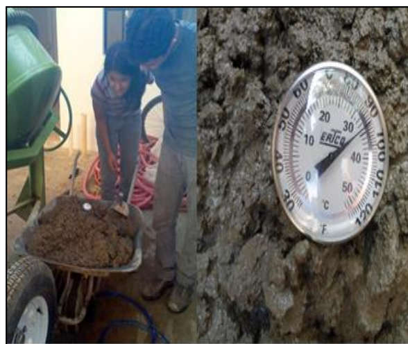
Imagen 3.17: Medición de temperatura al concreto Fuente: Grupo de Tesis
