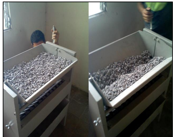
Imagen 3.4: Cuarteo Mecánico de Agregado Grueso
