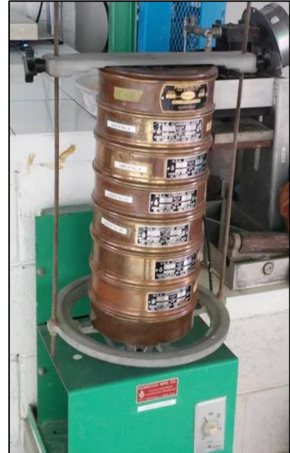
Imagen 3.11: Equipo Ro-Tap Fuente: Laboratorio MZ Consultores
