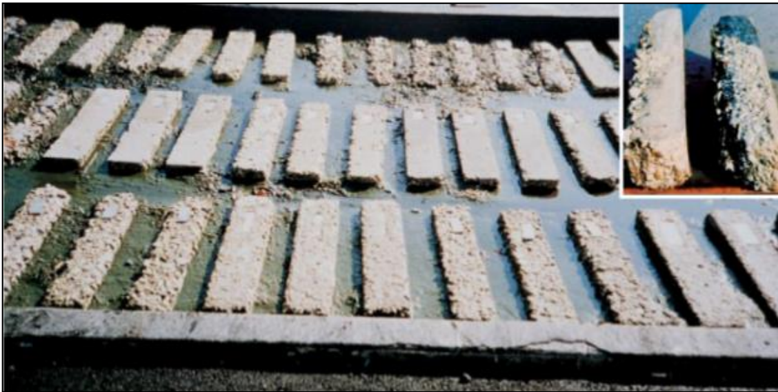
Figura 2.16: Vigas de concreto después de muchos años de exposición a un suelo con alta concentración de sulfatos en sacramento, california, terreno de ensayo.
