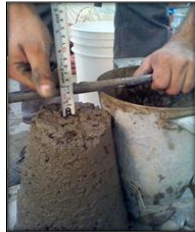
Imagen 3.16 Medición de revenimiento Fuente: Grupo de Tesis
