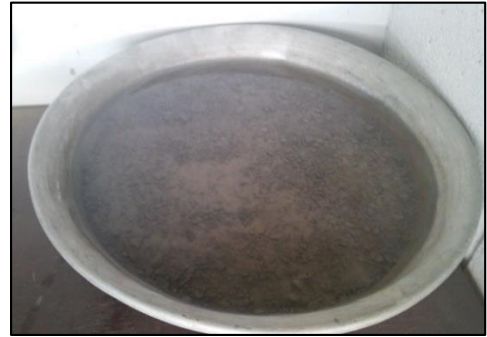
Imagen 3.8: Agregado Fino sumergido en Agua Fuente: Grupo de Tesis
