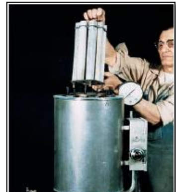
Figura 2.7: Prueba de sanidad Fuente: Libro Diseño y control de Mezclas de Concreto
