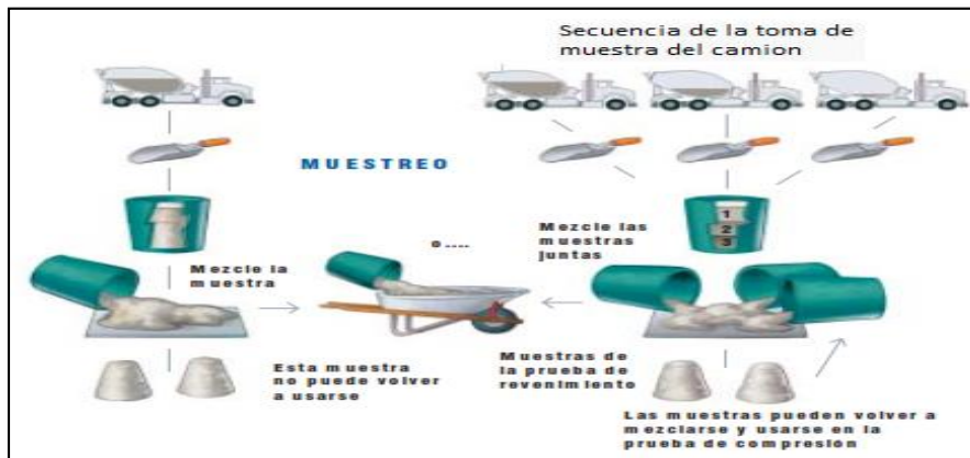
Figura 2.13: Pasos de proceso de muestreo Fuente: Normas Concreto Fresco y endurecido. Editado por el imcyc
