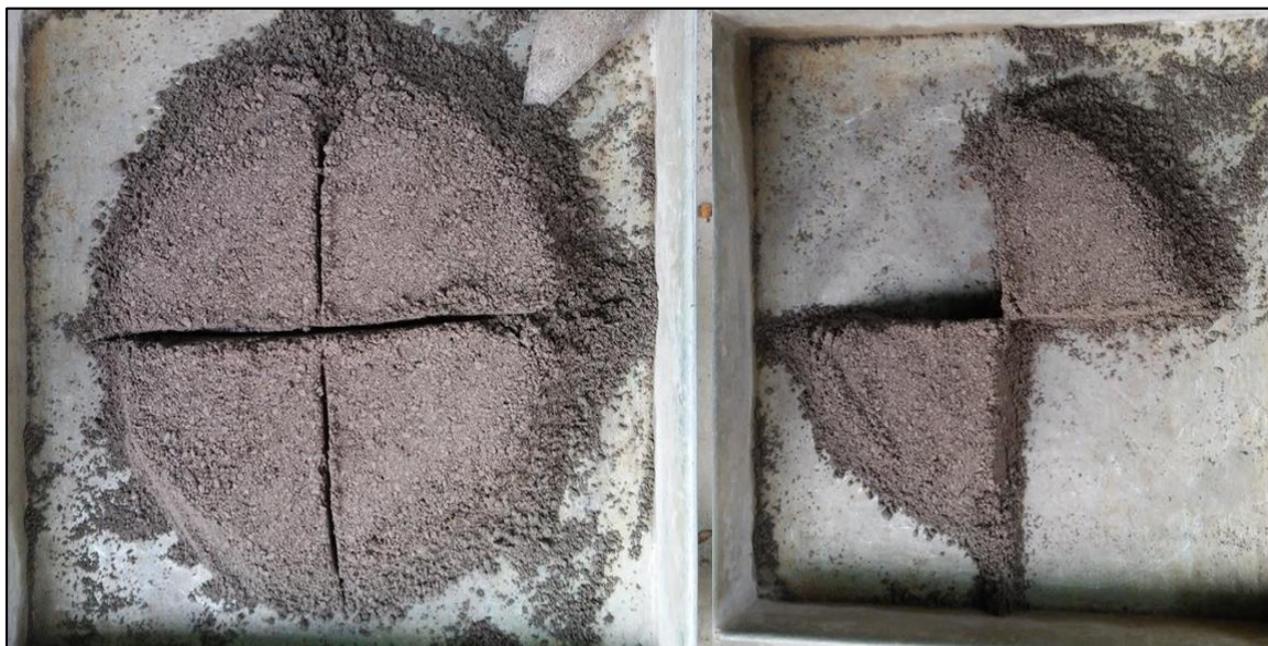
Imagen 3.6: Cuarteo Manual de Agregado Fino
