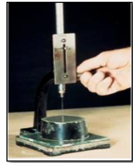
Figura 2.9: Ensayos de tiempo de fraguado usando aguja de Vicat Fuente: Libro Diseño y control de Mezclas de Concreto
