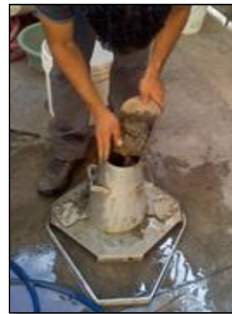
Imagen 3.15: Prueba de revenimiento Fuente: Grupo de Tesis
