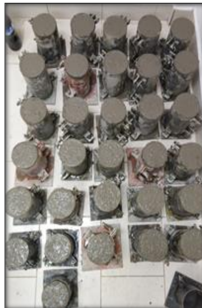
Imagen 3.18: Concreto moldeado Fuente: Grupo de Tesis
