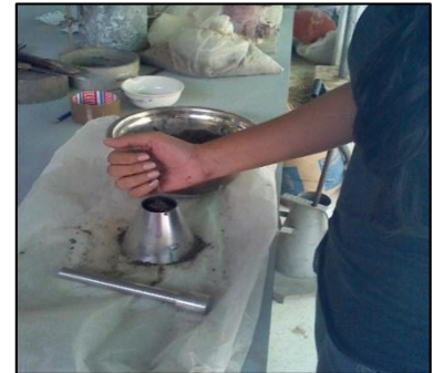
Imagen 3.9: Prueba para humedad superficial Fuente: Grupo de Tesis
