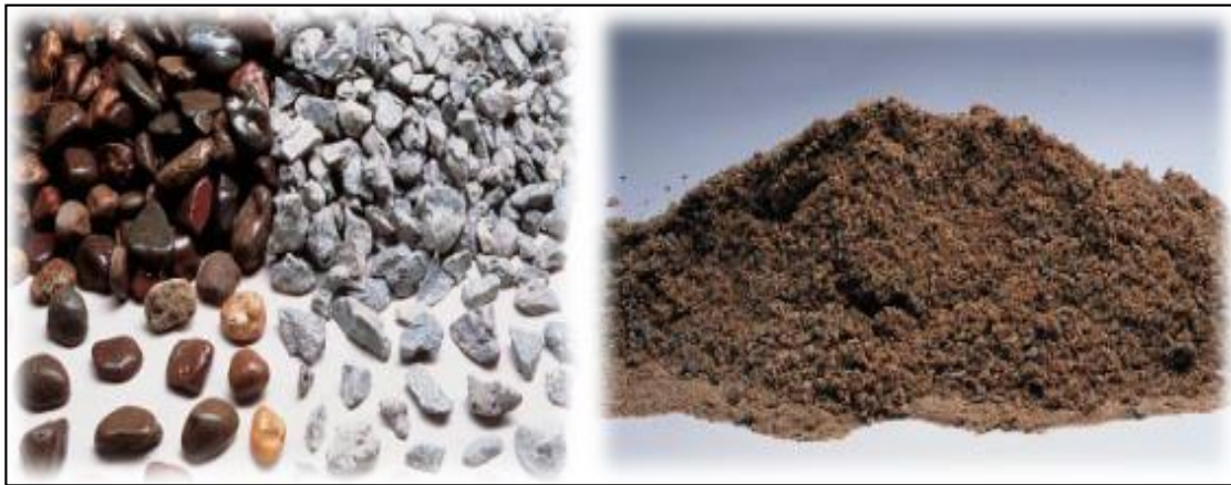
Figura 2.5: Agregados para el concreto Fuente: Libro Diseño y control de Mezclas de Concreto
