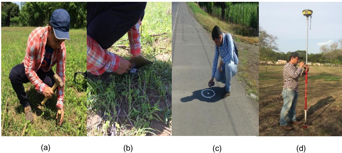
Figura 45. Procedimiento de colocación de marcas y medición de coordenadas para GCPs.
