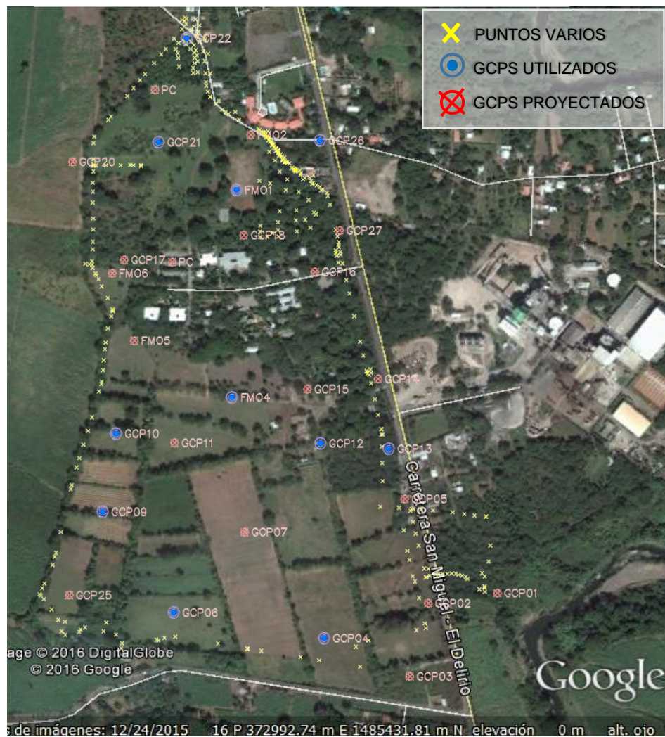
Figura 55. Ubicación de los puntos tomados durante la fase de apoyo topográfico. Fuente: Imagen satelital recuperada de Google Earth y proyección de los puntos en AutoCAD Civil 3D por el Grupo de tesis.
