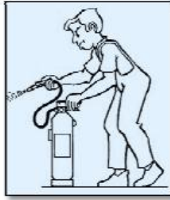
Figura 29. Realizar descarga de comprobación
