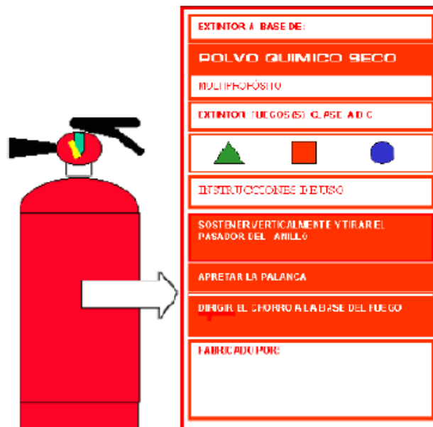
Figura N.26 Etiqueta de Identificación del Extintor
