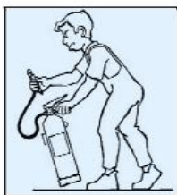
Figura N.28 Asir la manguera por la boquilla
