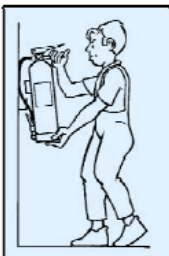
Figura N.27 Descolgar el extintor
