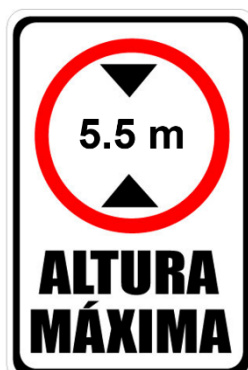
Figura 25: Ejemplo de señalización indicando la altura máxima transitable sobre el puente peatonal.
