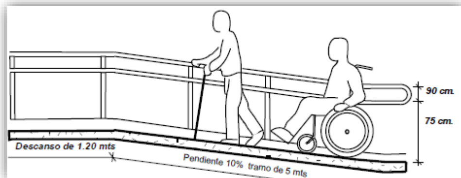
Figura 11: Detalle de pendiente de rampa
