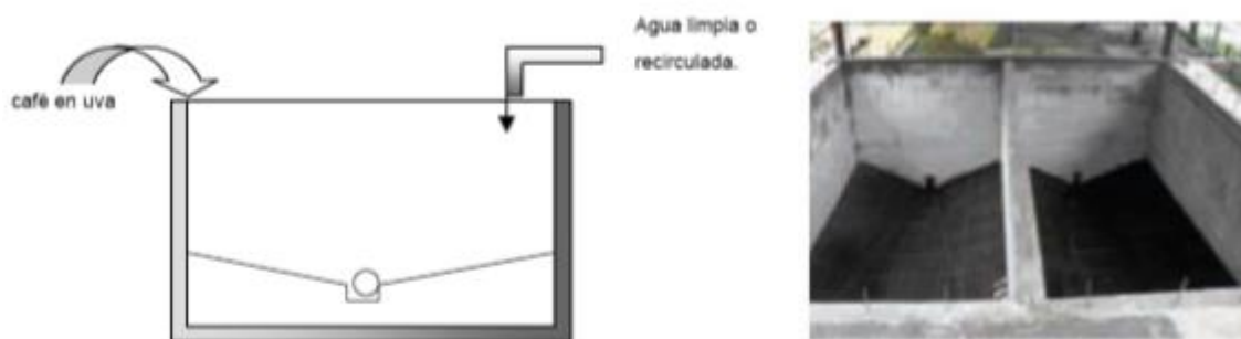
Ilustración 34: Pilas y tanques de ribo de café en el Beneficio.
