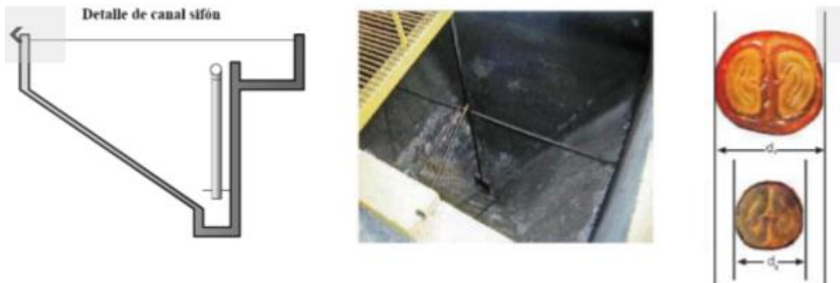
Ilustración 37: Detalle de canal de sifón, para clasificación hidrostática.
