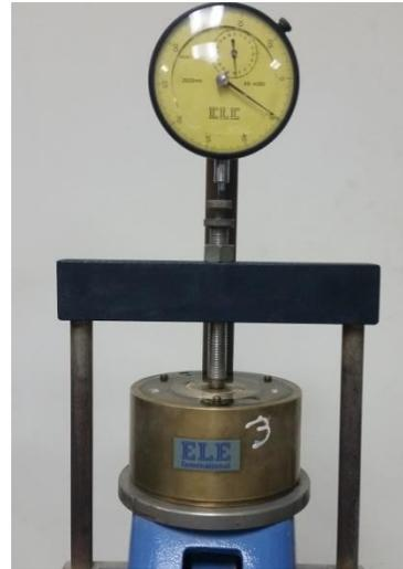
**Fotografía 3.61** Toma de lecturas del deformímetro en la etapa de descarga
