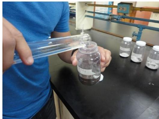
**Fotografía 3.67** Colocación del agua a la mezcla suelo-cal
