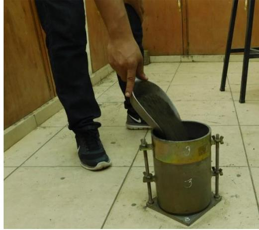
**Fotografía 3.46** Colocación de material para formar las capas de compactación
