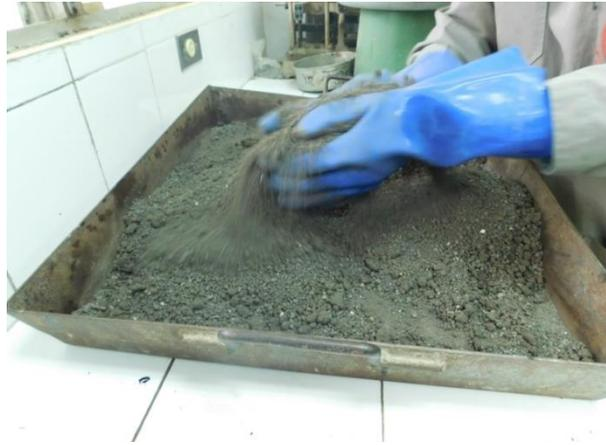
**Fotografía 3.44** Mezclando el suelo al añadirle agua para obtener un suelo homogéneo
