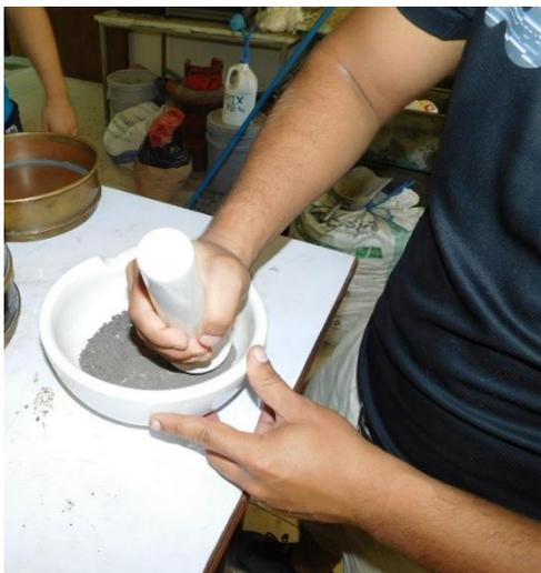
**Fotografía 3.6** Pulverización de la muestra
