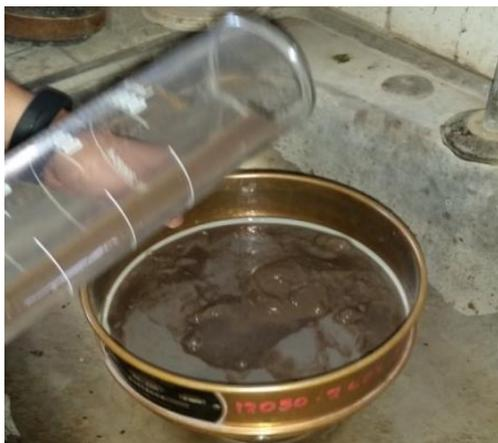
**Fotografía 3.30** Lavado del material de ensayo en la malla No 200
