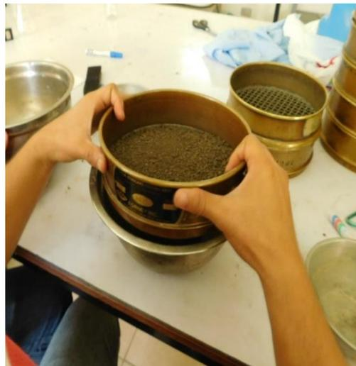
**Fotografía 3.7** Tamizado de la muestra por la malla No 40
