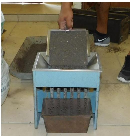
**Fotografía 3.4** Vertiendo el material en el cuarteador de muestras para obtener una muestra bien distribuida
