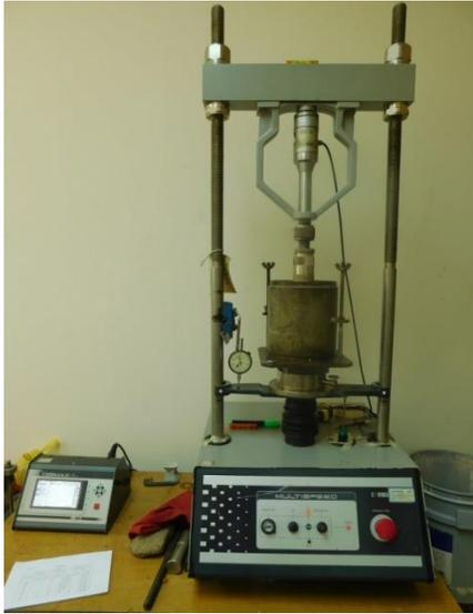
**Fotografía 3.49** Molde colocado listo para la penetración en la Máquina Marshall manual
