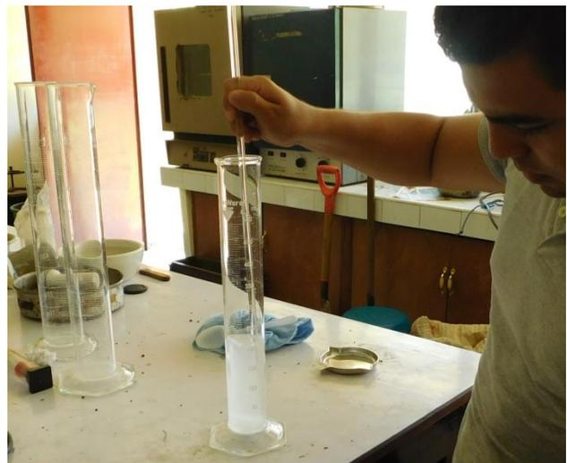
**Fotografía 3.25** Agitando la solución hasta disolver el hexametfosfato de sodio
