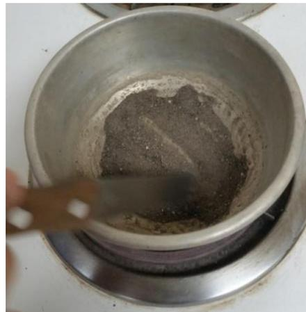
**Fotografía 3.31** Secando el material lavado en la cocina hasta obtener masa constante
