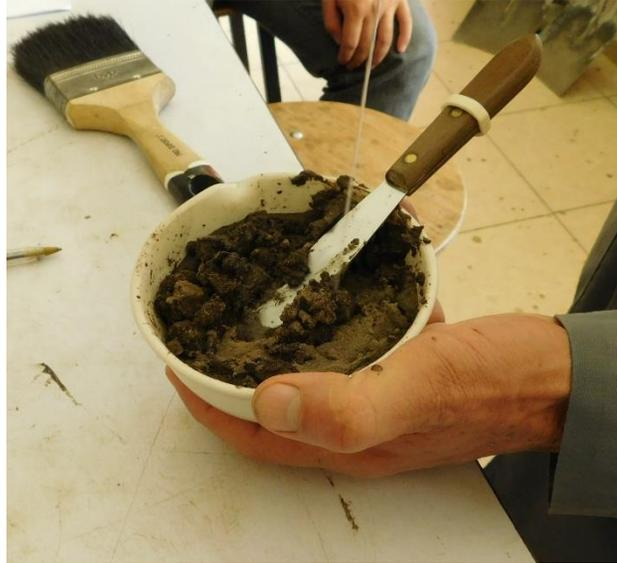
**Fotografía 3.8** Hidratación y homogenización de la muestra
