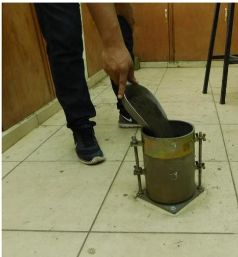
**Fotografía 3.36** colocación del suelo en el molde.
