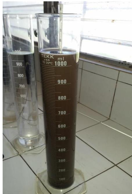
**Fotografía 3.29** Tomando lecturas del hidrómetro en los intervalos de tiempo
