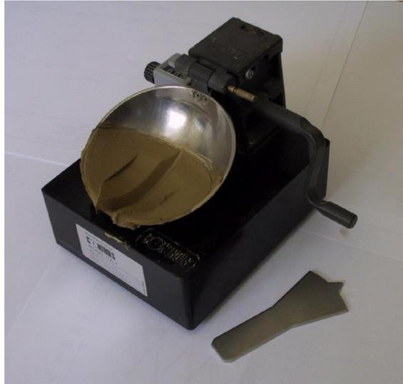
**Fotografía 3.9** Dispositivo de límite líquido y muestra de suelo
