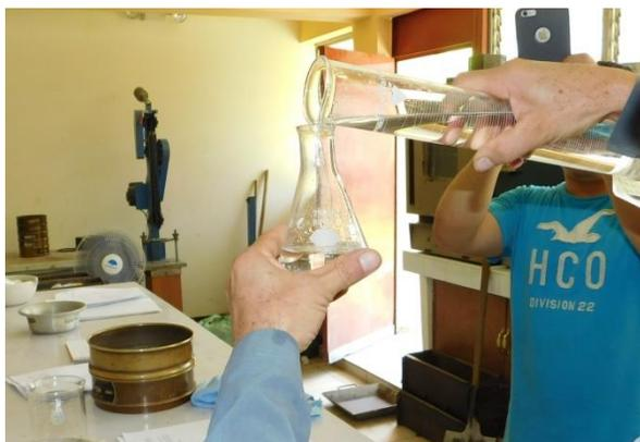
**Fotografía 3.26** Colocando 125 ml de defloculante en el Erlenmeyer
