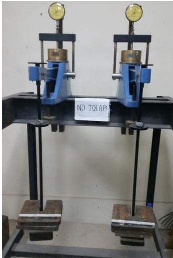
**Fotografía 3.60** Etapa de descarga (primer decremento de carga en las varillas colgantes)
