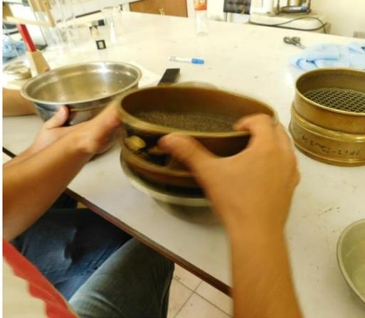
**Fotografía 3.22** Pasando la muestra de suelo por el tamiz No 10
