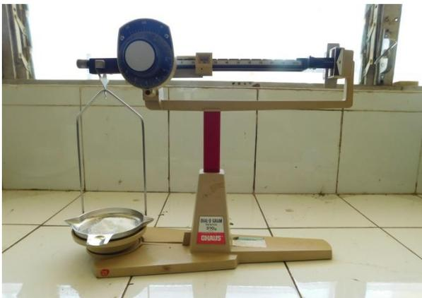
**Fotografía 3.24** Tomando la masa de 20 g de hexametfosfato de sodio para la preparación de la solución
