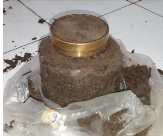
**Fotografía 3.53** Probeta moldeada al anillo solo de cortar horizontalmente
