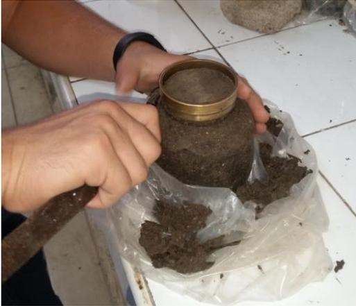
**Fotografía 3.52** Moldeando el suelo a imagen del anillo de consolidación
