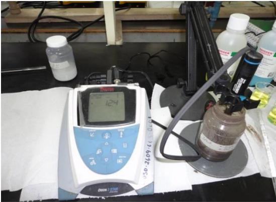
**Fotografía 3.68** Medición del pH a la mezcla cal-agua
