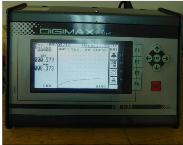
**Fotografía 3.50** Obtención de la carga aplicada en KN en la pantalla del control de mando
