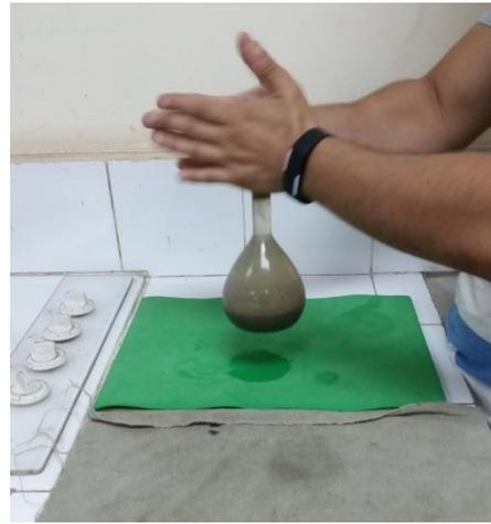
**Fotografía 3.18** Extracción de aire mediante el agitación del matraz
