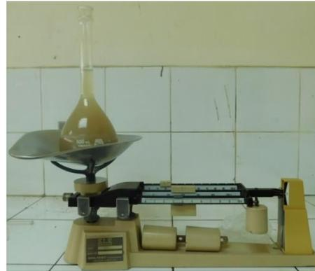
**Fotografía 3. 20** Obtención de la masa del matraz + agua + suelo (aforado)
