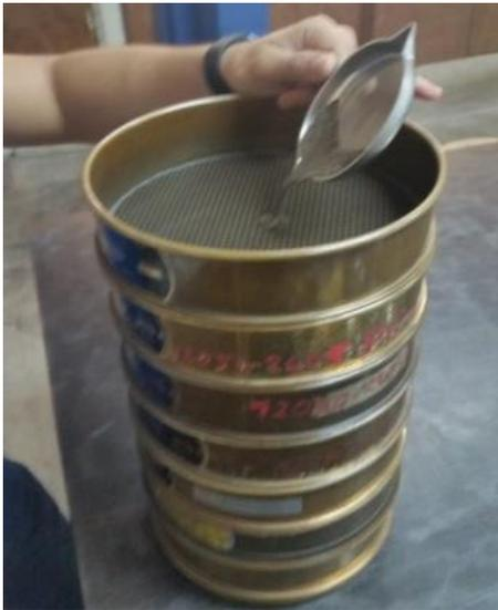
**Fotografía 3.32** Depositando el material secado a la cocina para tamizarlo
