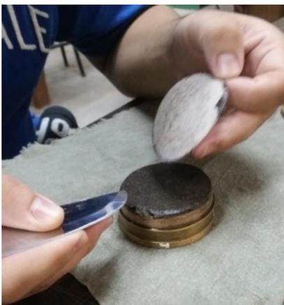
**Fotografía 3.62** Desmonte del consolidómetro
