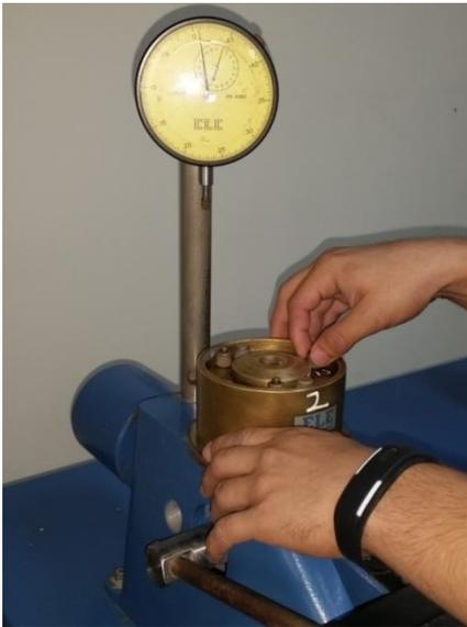
**Fotografía 3.56** Colocación del consolidometro en el centro del marco de consolidación
