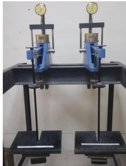
**Fotografía 3.59** Etapa de carga (último incremento de carga en las varillas colgantes)
