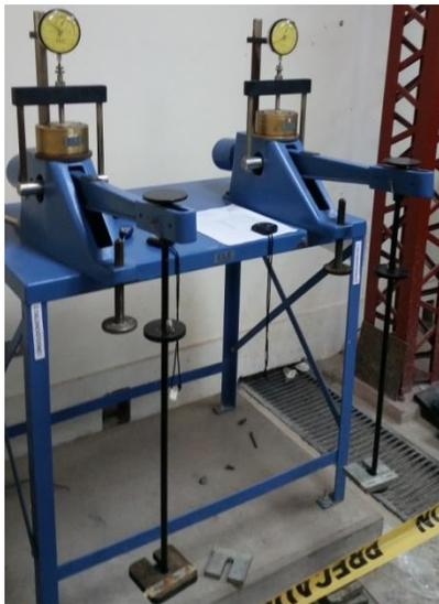
**Fotografía 3.58** Etapa de carga (primer incremento de carga en las varillas colgantes)
