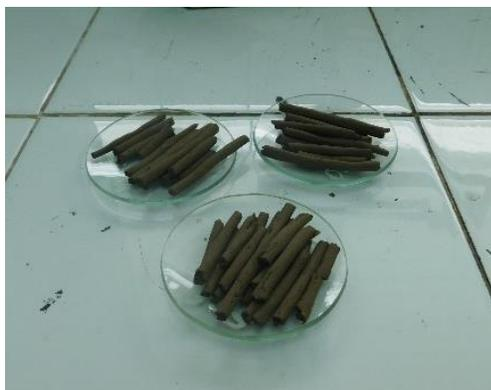
**Fotografía 3.11** Muestras de suelo para determinar la humedad correspondiente al límite líquido
