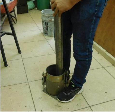
**Fotografía 3.45** Compactación de las capas de suelo en el molde
