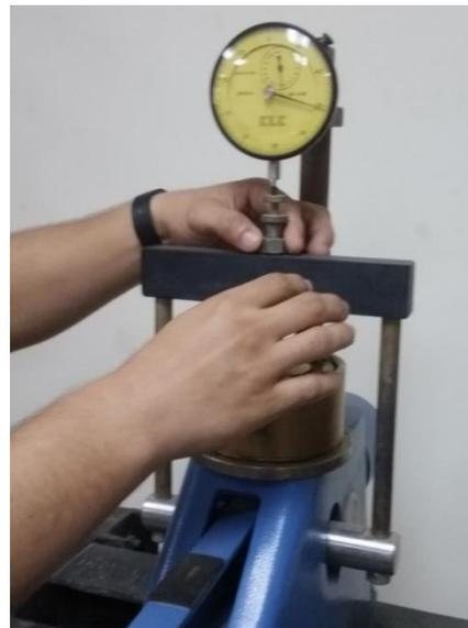
**Fotografía 3.57** Fijación de tornillos del marco de carga y colocación del deformimetro
