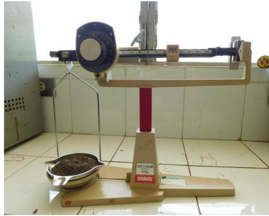
**Fotografía 3.23** Pesando los 65 g de suelo para realizar el ensayo
