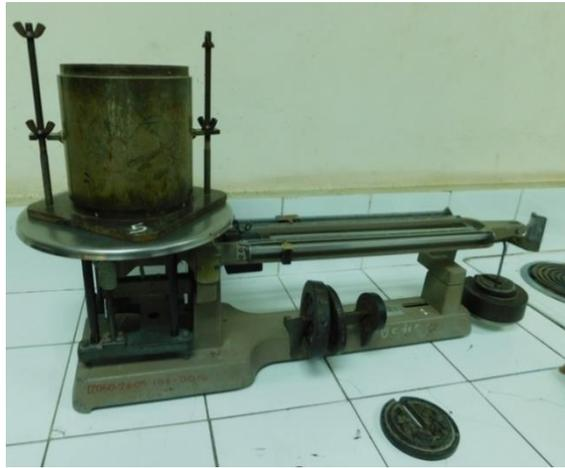
**Fotografía 3.48** Obtención del peso saturado de la muestra compactada
