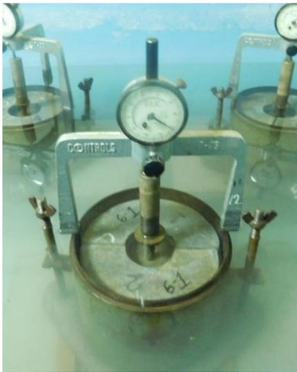
**Fotografía 3.47** Moldes de compactación sumergidos para obtener el hinchamiento
