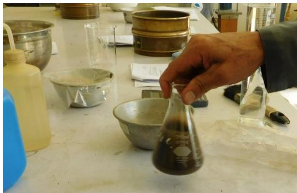
**Fotografía 3.27** Agitando la solución hasta formar una lechada
