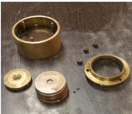
**Fotografía 3.54** Colocación de los tornillos del aro de sujeción del espécimen de suelo
