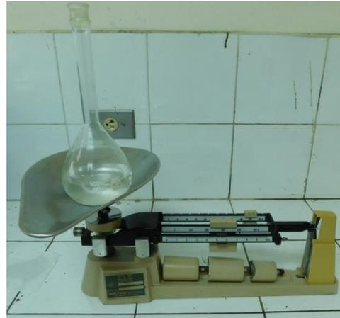
**Fotografía 3.14** Obtención de la masa del matraz + agua a una altura de  $\frac{1}{2}$  del bulbo
