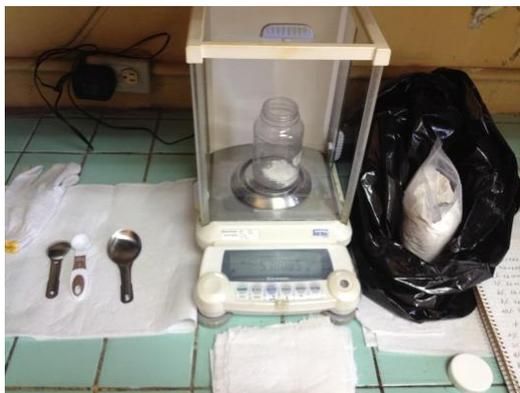
**Fotografía 3.66** Colocación de la cal dentro del recipiente con suelo
