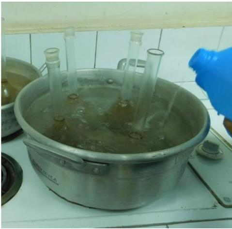
**Fotografía 3.17** Etapa de ebullición en la extracción de aire de los matraces
