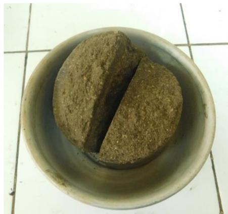
**Fotografía 3.41** Muestra para cálculo de humedad compactada
