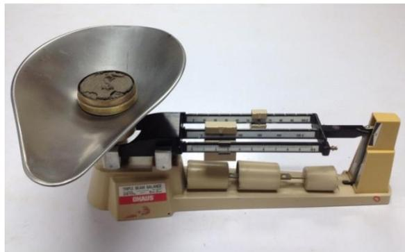
**Fotografía 3.63** Obtención de la masa seca del espécimen de suelo con el anillo de consolidación
