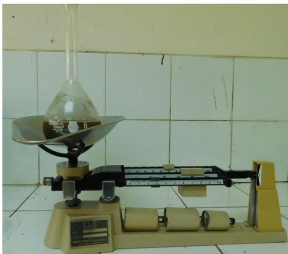
**Fotografía 3.15** Obtención de la masa del matraz + agua + suelo
