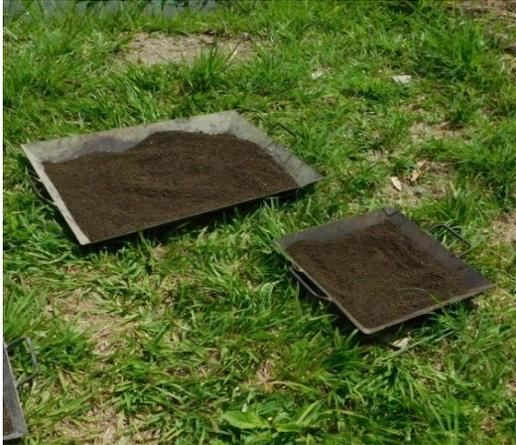
**Fotografía 3.43** Secando al aire la muestra de suelo para ensayo
