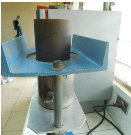
**Fotografía 3.40** Extracción de la muestra compactada
