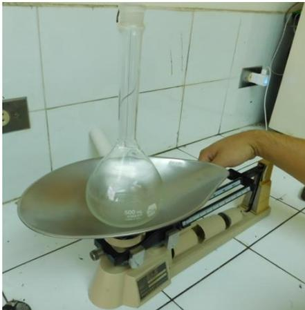
**Fotografía 3.13** Obtención de la masa del matraz limpio y seco
