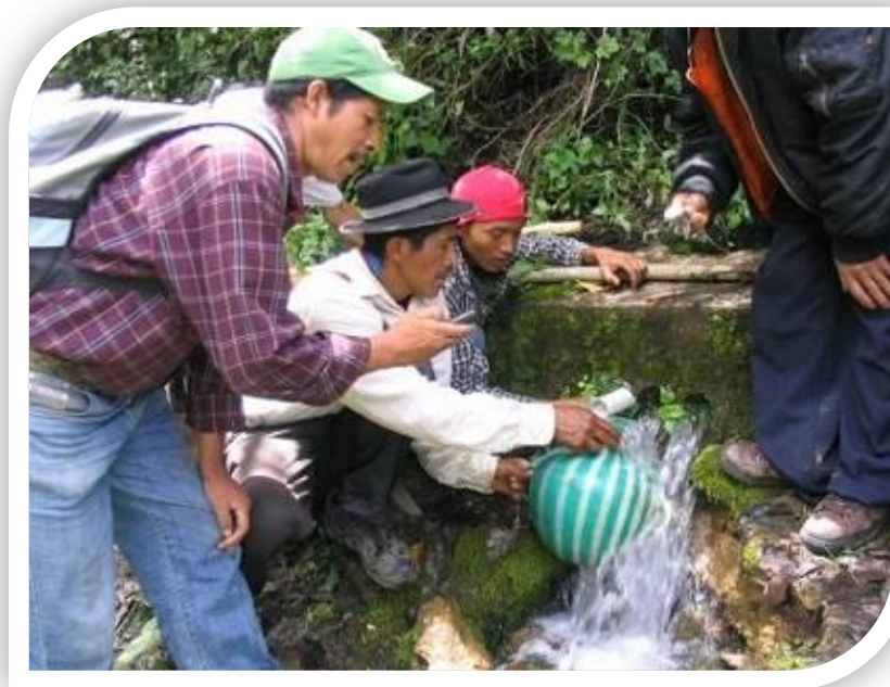
Figura 5.24. Medición de caudal en los nacimientos
