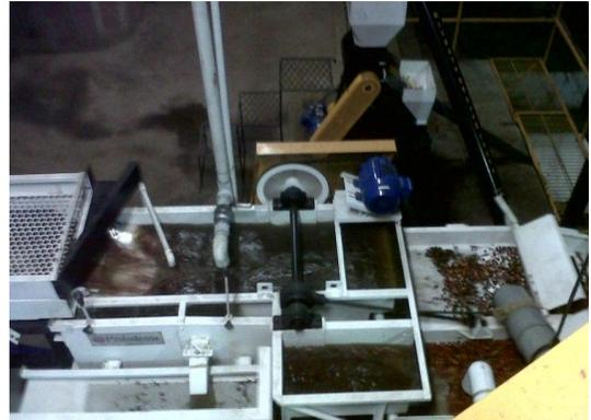
SIFON CLASIFICADOR DE UVA Y FLOTES, SECCION DESPULPE,
