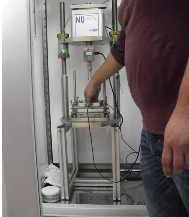
Figura 3.62. Montaje del marco para LVDT's sobre el marco de alineación. Fuente: Registro Propio.
