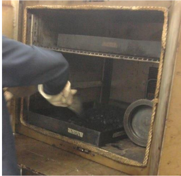
Figura 3.34. Acomodamiento de bandejas y molde de compactador giratorio dentro del horno. Fuente: Registro propio.
