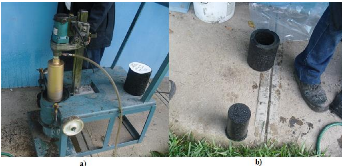
Figura 3.49. . Extracción de núcleo. a) Perforación de briqueta de 6" para obtener núcleo de 4" de diámetro. b) Núcleo extraído. El material sobrante de la extracción fue desechado debido a su contacto con el aceite al momento de la compactación.
