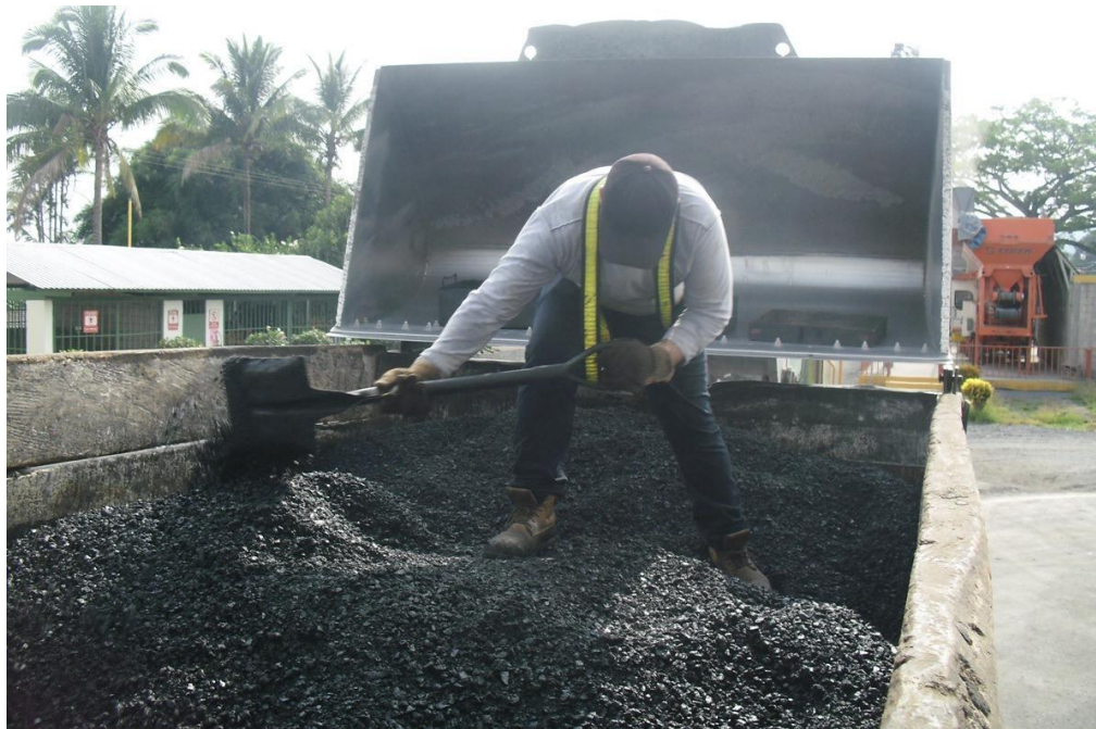
Figura 3.17. Remoción de material para homogenizar la muestra.
