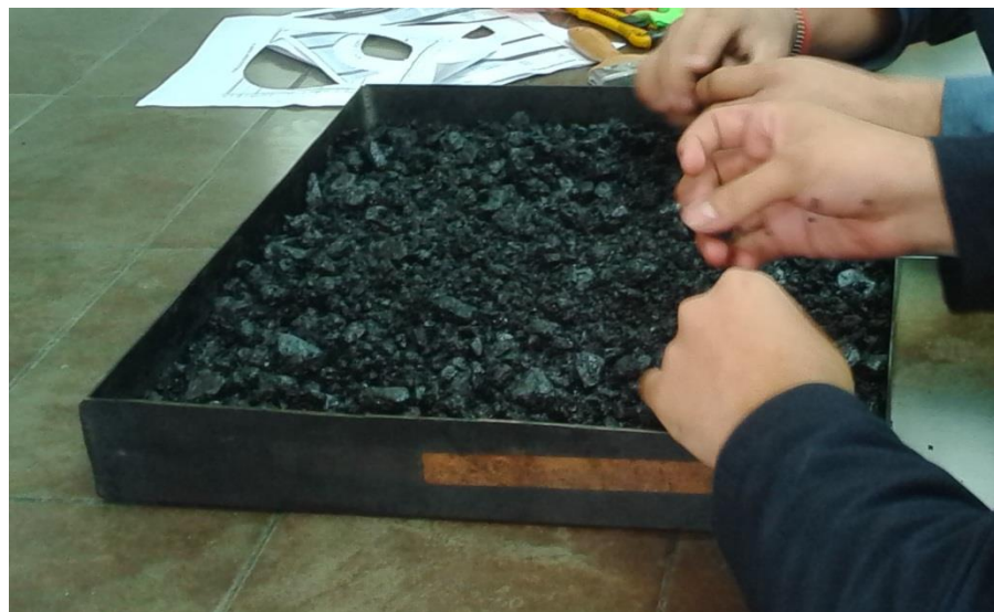
Figura 3.33. Revisión de mezcla extendida en la bandeja. Se desmenuzaron los grumos y enraso la superficie. Fuente: Registro propio.
