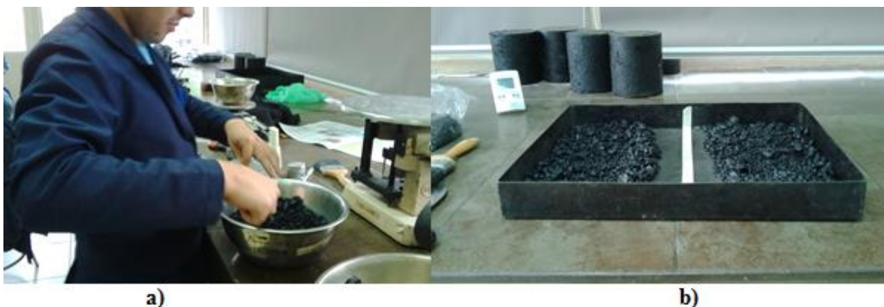
Figura 3.32. Preparación de mezcla a acondicionar para compactación Marshall. a) Mezcla depositada en charola. b) Mezcla colocada en bandeja. En ambos casos los recipientes deben estar cebados.
