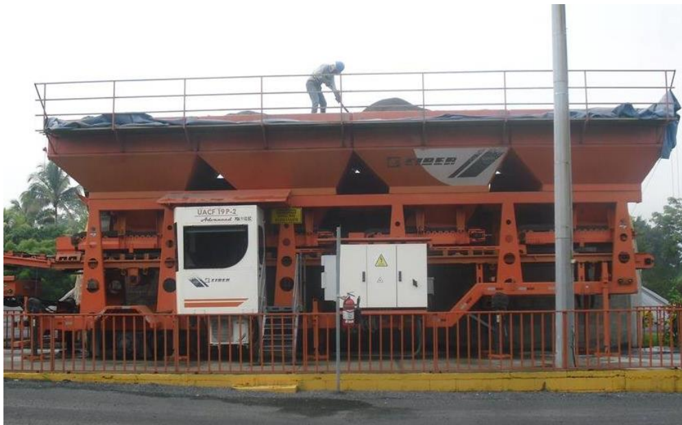
Figura 3.5. Silos dosificadores. Permiten la adecuada separación de los agregados para evitar errores durante la descarga de dosificación.
