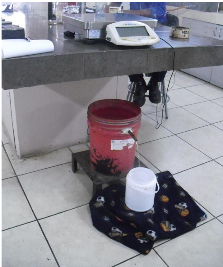
Figura 3.54. Equipo preparado para determinación de pesos sumergidos y saturado superficialmente seco (SSS).
