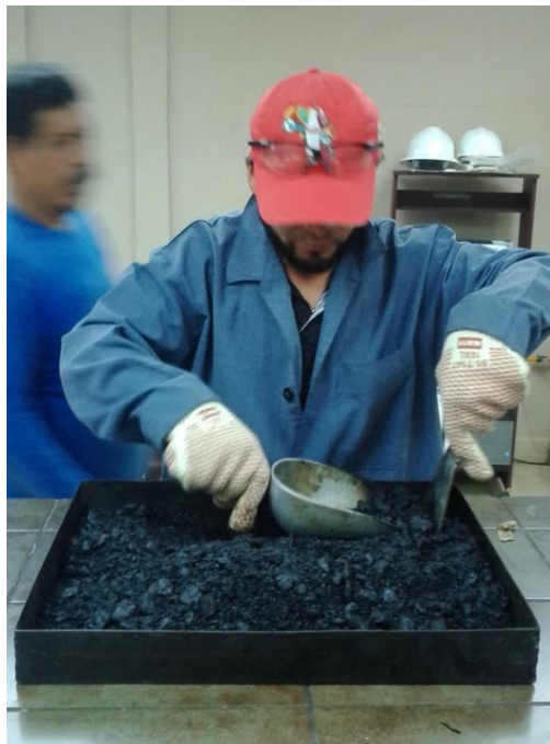
Figura 3.35. Revoltura de mezcla. Esta se hizo lo más rápido posible para evitar pérdida de calor. Fuente: registro propio.
