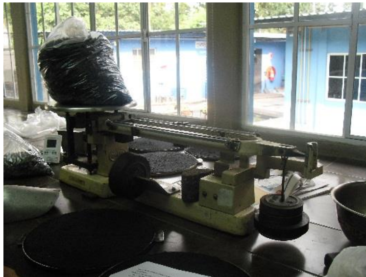
Figura 3.25. Pesaje de material cuarteado. El peso de las bolsas plásticas fue tomado en cuenta. Fuente: Registro propio.
