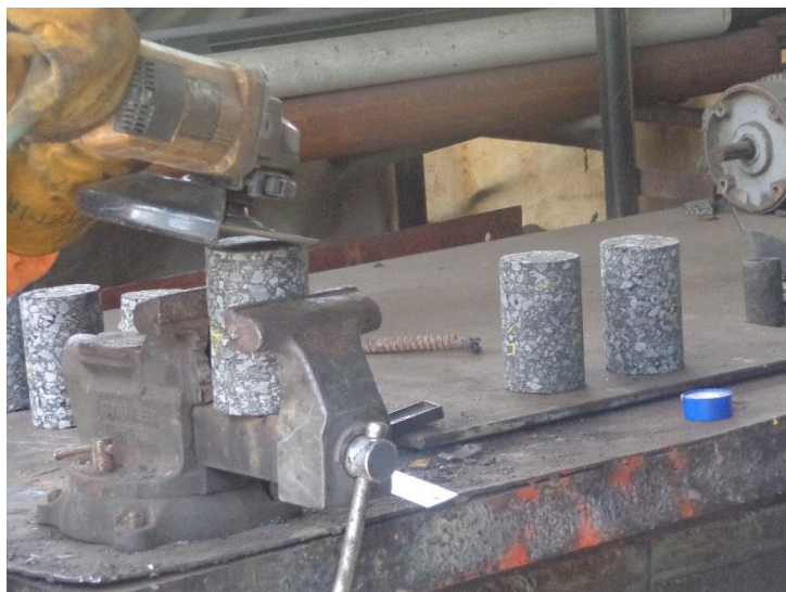
Figura 3.52. Pulido de núcleos para reducir las imperfecciones de los bordes. Se contó con ayuda del personal del taller de la planta. Fuente: Registro propio.
