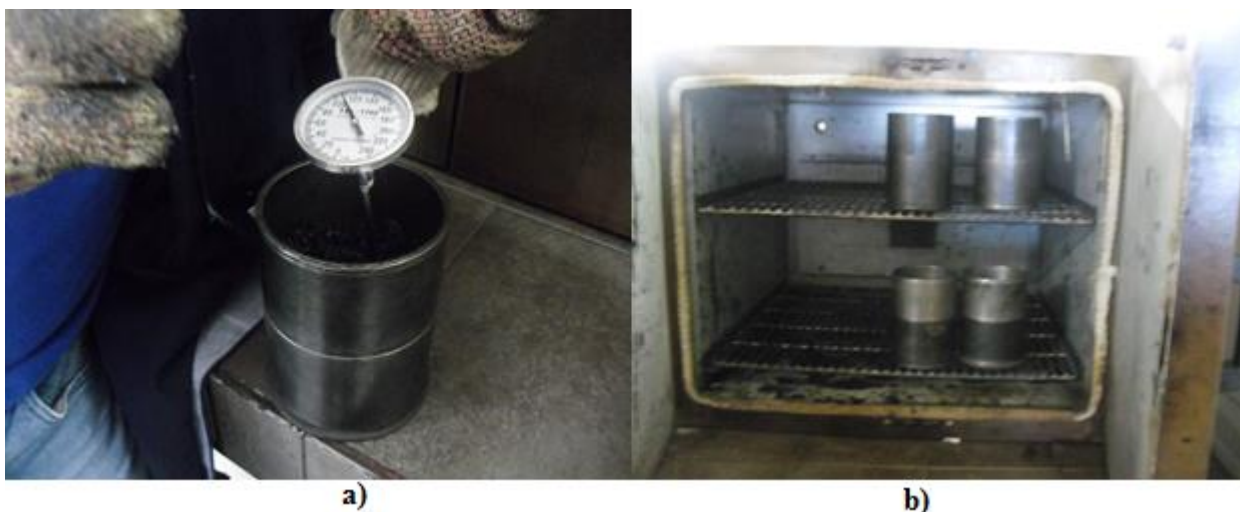
Figura 3.37. Monitoreo de temperatura de la mezcla enmoldada. a) Medición de temperatura de la mezcla. b) Moldes con mezcla puestos en el horno. El horno se cerraba inmediatamente. Fuente: Registro propio.
