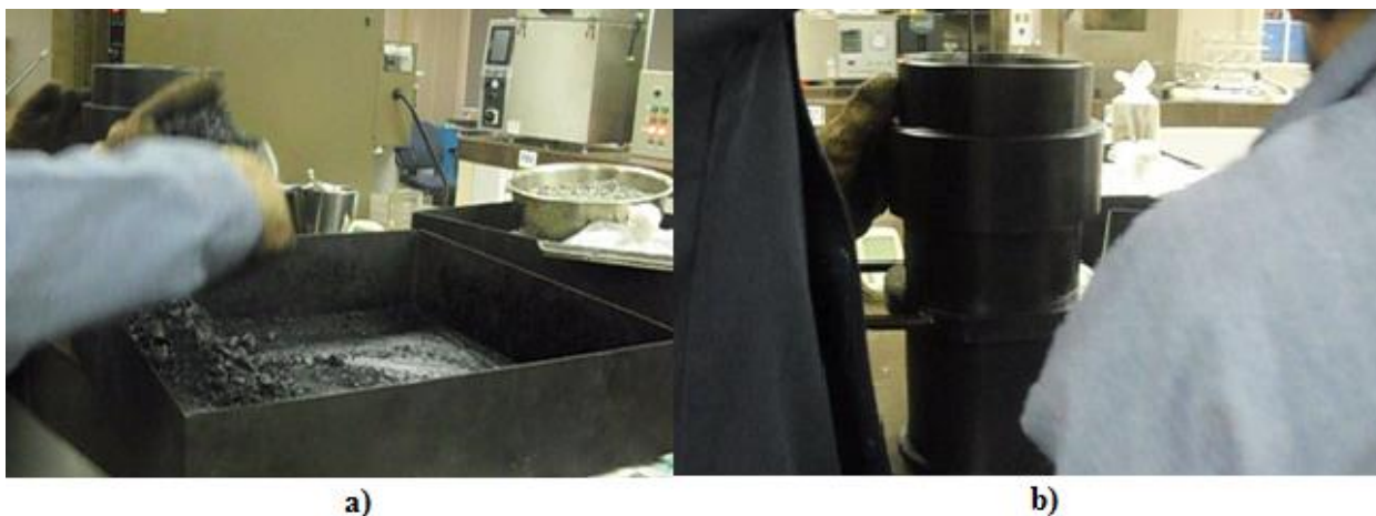
Figura 3.44. Enmoldado de mezcla para Compactador Giratorio. a) Colocación de mezcla en el molde. b) Varillado de mezcla enmoldada. Fuente: Registro propio.
