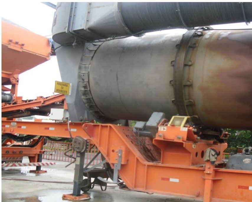
Figura 3.8. Incorporación del agregado al tambor secador. El tambor tiene la función exclusiva de secar y calentar los agregados. Fuente: Registro propio.
