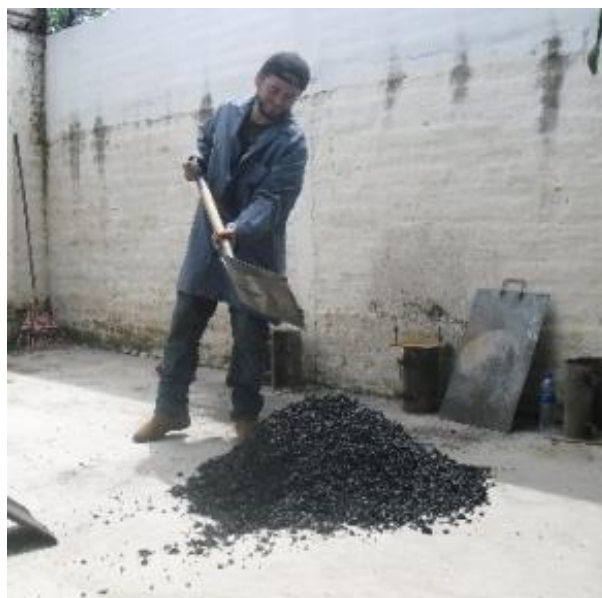
Figura 3.22. Formación de pila cónica durante el cuarteo.
