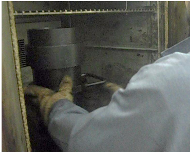
Figura 3.45. Colocación de molde con mezcla en el horno para recuperación de temperatura. Fuente: Registro propio.
