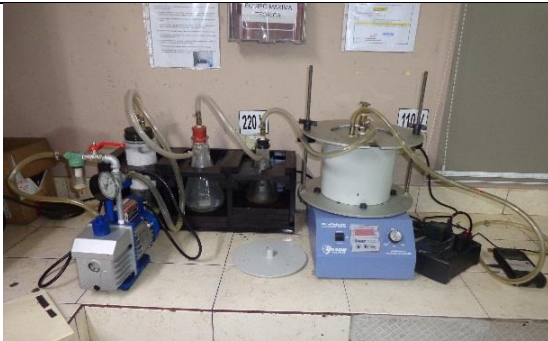
Equipo para determinación de gravedad máxima teórica (Bomba de vacío, agitador mecánico, picnómetro, calibrador de vacío y manómetro de presión residual)
