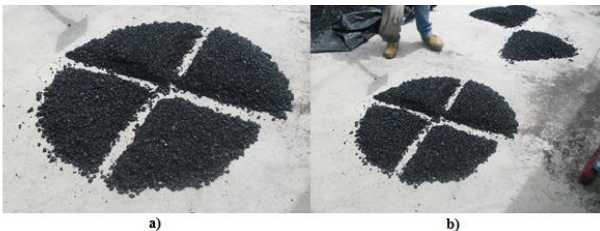
Figura 3.24. División de la mezcla cuarteada en partes iguales.
