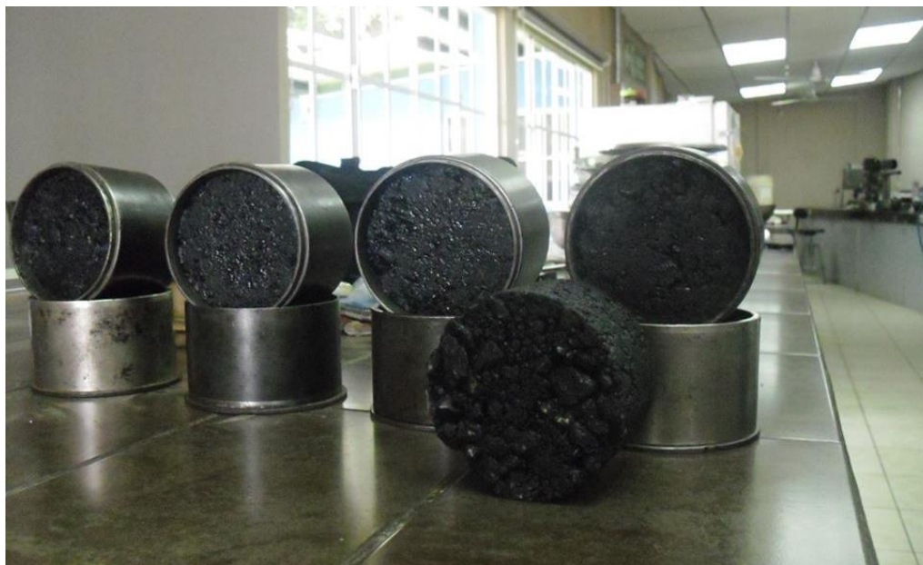
Figura 3.40. Disposición de los moldes para enfriamiento. El lado expuesto de las briquetas fue el último en recibir golpes. Fuente: Registro propio.
