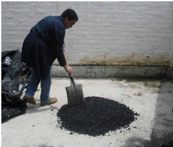
Figura 3.23. Aplanado de pila cónica.
