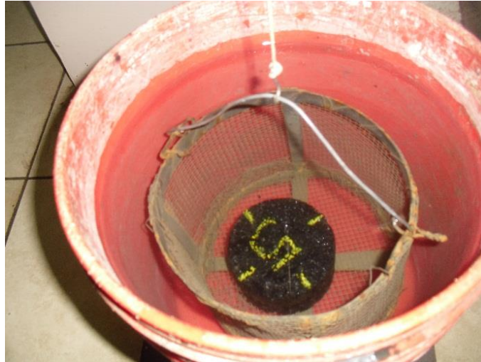
Figura 3.55. Briqueta sumergida en agua. Fuente: Registro propio.
