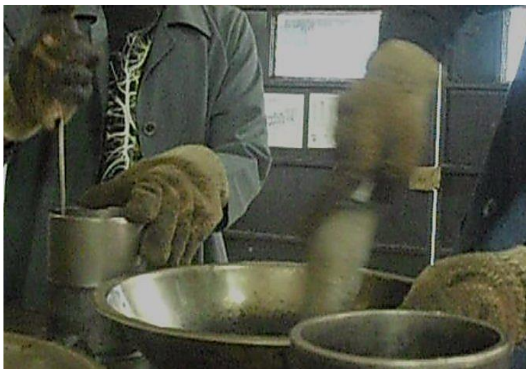
Figura 3.36. Enmoldado de mezcla. Los golpes con la barra se aplicaron la fuerza suficiente para acomodar toda la mezcla. Fuente: Registro propio.
