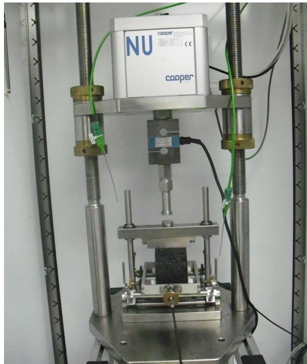
Figura 3.63. Briqueta preparada para comenzar el ensayo. Fuente: Registro propio.
