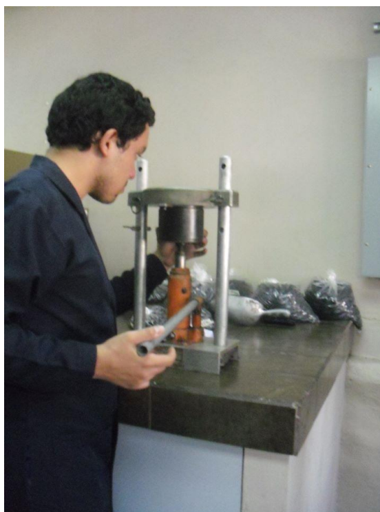
Figura 3.41. Desmoldado de briquetas. Fuente: Registro propio
