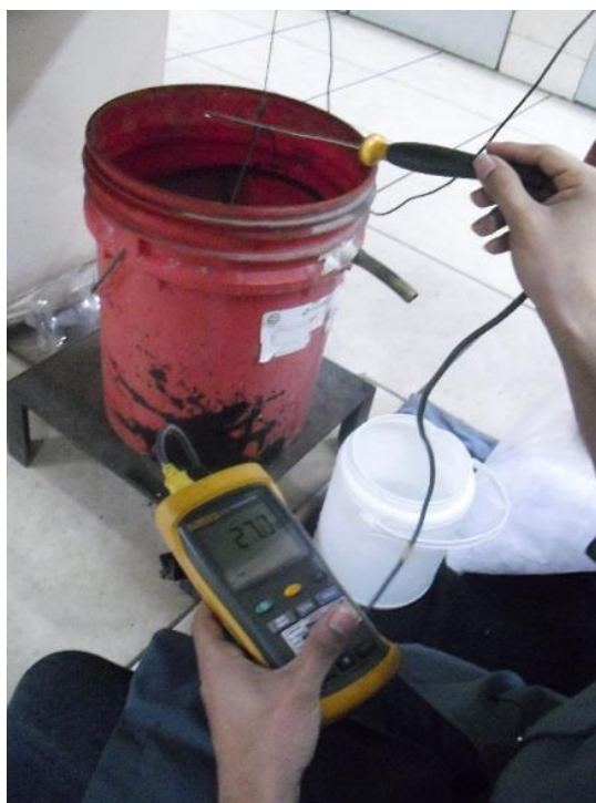
Figura 3.53. Temperado del agua en la cubeta. En todo momento tanto el agua de la cubeta como el agua a agregar para lograr los aforos, debían cumplir con el rango de temperatura. Fuente: Registro propio.
