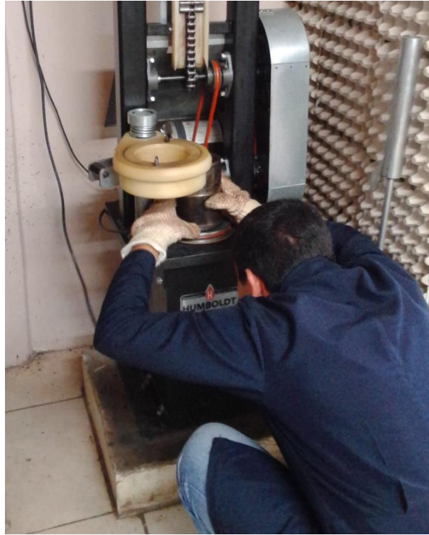
Figura 3.38. Colocación del molde en el pedestal para compactación. Los pines del pedestal se encajaron con los agujeros en la base del molde. Fuente: Registro propio.
