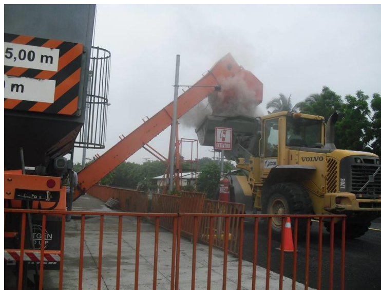
Figura 3.16. Silo descargando mezcla terminada en una pala cargadora para inspección inicial. Fuente: Registro propio.
