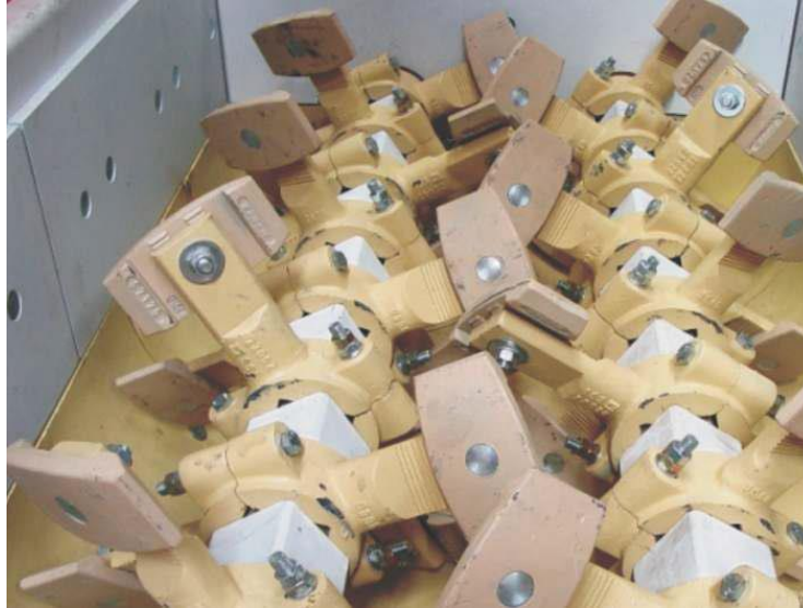
Figura 3.13. Vista interna del mezclador. Fuente: (CIBER, 2015).
