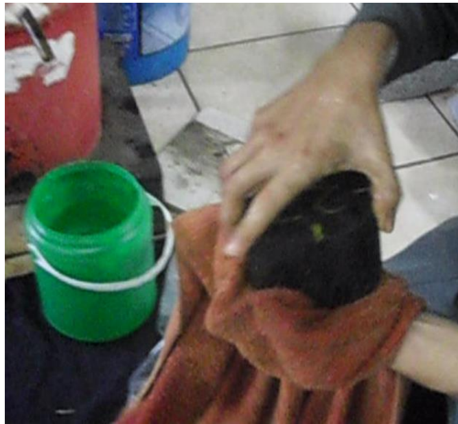
Figura 3.56. Secado de briqueta para obtener condición saturada superficialmente seca (SSS). Fuente: Registro propio.
