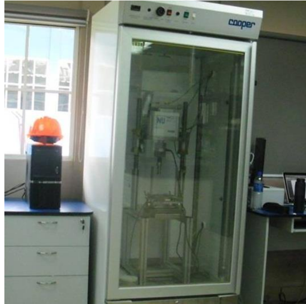
Figura 3.58. Marco de carga del equipo Nottingham Asphalt Tester (NAT) tipo NU. Fuente: Registro propio.
