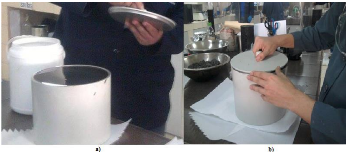
Figura 3.31. Aforo de picnómetro. a) Picnómetro listo para aforar. b) Picnómetro aforado. La colocación de la tapa debe hacerse con cuidado y despacio, permitiendo que el exceso de agua salga por el agujero de la tapa. Fuente: Registro propio.
