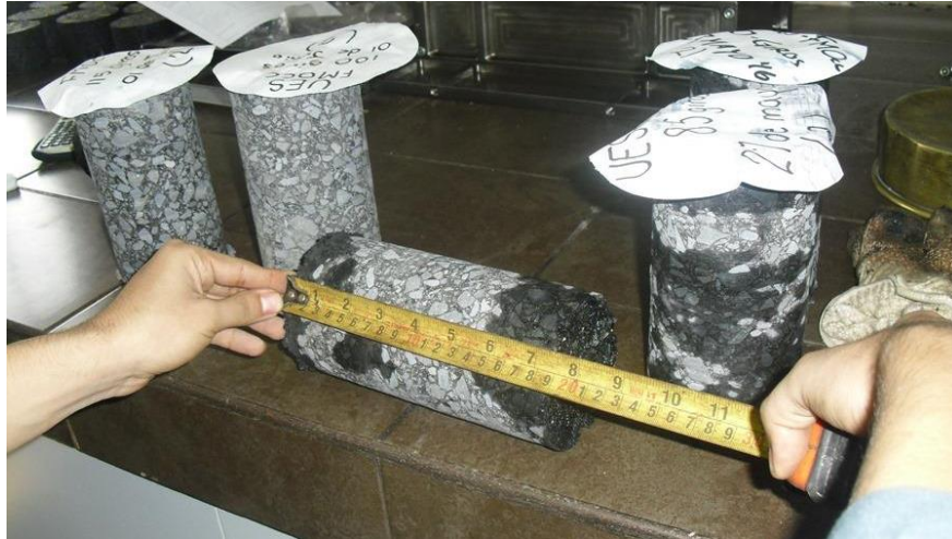
Figura 3.50. Medición de altura en núcleo extraído. Se colocó marcas a los 150 mm. Fuente: Registro propio
