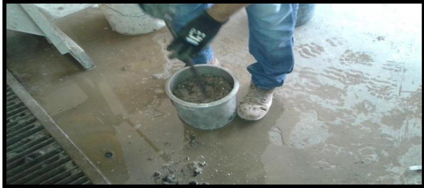
**FIGURA 3.20 Varillado para ensayo de contenido de aire**
