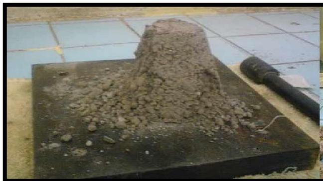
**FIGURA 3.13** Determinación de la condición saturada superficialmente seca en muestra de arena
