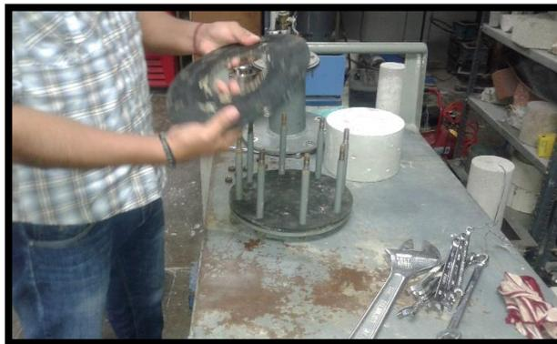
**FIGURA 3.35 Colocación de lámina de neopreno**
