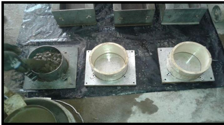
**FIGURA.3.24 Llenado de cilindros para ensayo de permeabilidad cilindros de 20 x 12 cms**
