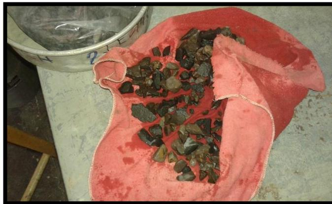
**FIGURA 3.11 Secado superficial del agregado grueso**
