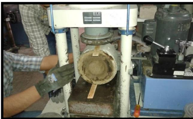
**FIGURA 3.42** Ensayo brasileño para romper por mitad la muestra
