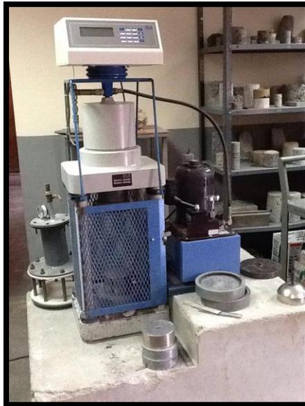
FIGURA 3.31 Máquina de compresión de cilindros estándar
