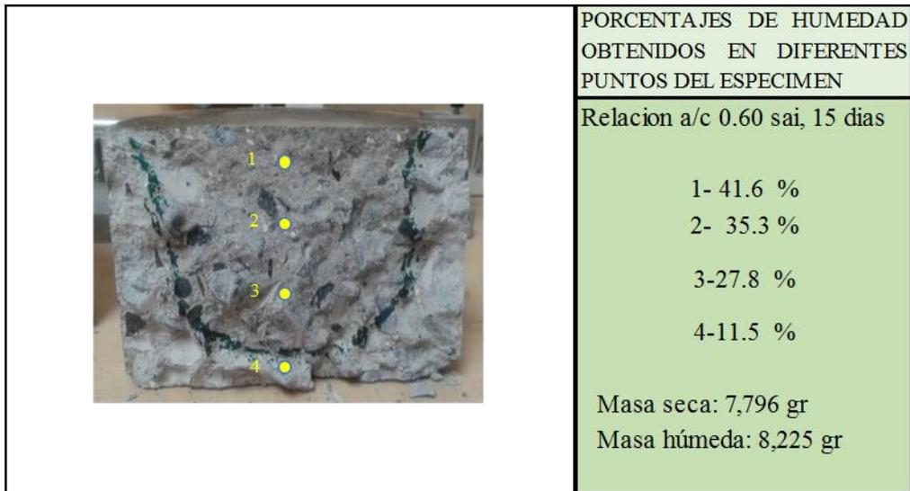
FIGURA 4.32 Porcentaje de humedad obtenido en diferentes puntos de espécimen ensayado en prueba de permeabilidad concreto relación A/C 0.60 sin aire incluido
