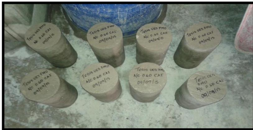
FIGURA 3.27 Especímenes elaborados con una relación agua/cemento 0.60 con aire incluido
