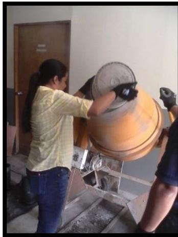
**FIGURA 3.16** Vertido de agregados en concretera
