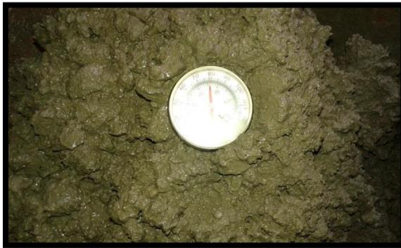
**FIGURA 3.23 Determinación de la temperatura**
