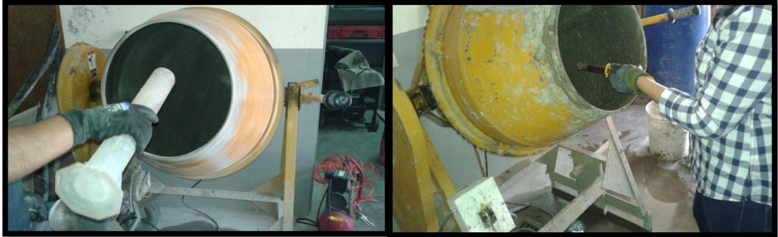
**FIGURA 3.17 Incorporación de agua y aditivo inclusor de aire en la mezcla**
