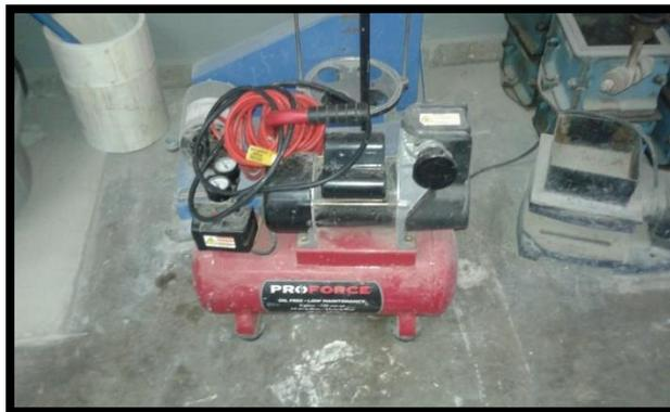
**FIGURA 3.29** Compresor de aire de 125 psi
