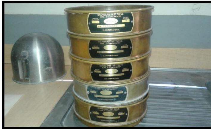
**FIGURA 3.7 Tamices certificados de abertura cuadrada para agregado grueso**
