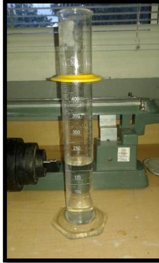
FIGURA 3.30 Probeta graduada de 500 ml
