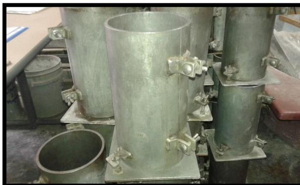
*FIGURA.3.14 Molde cilíndricos de 15 x 30 cms de diámetro*
