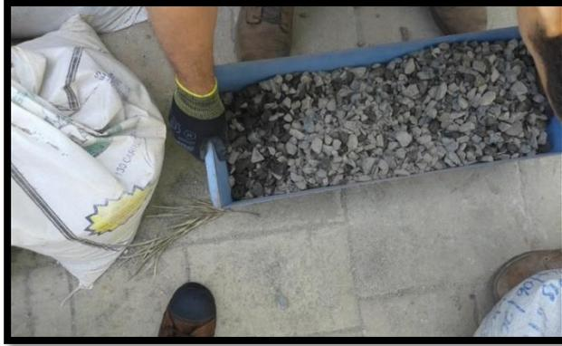
**FIGURA 3.2** Muestra de agregado grueso tamaño nominal  $\frac{3}{4}$ "
