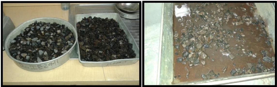
**FIGURA 3.10** Muestras en estado superficialmente secas y saturadas
