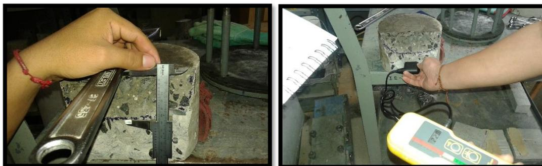
**FIGURA 3.43** Medida de profundidad de penetración y lectura de humedad
