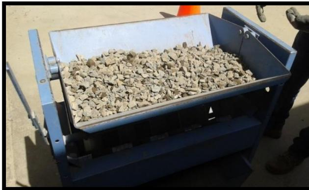
**FIGURA 3.3** Cuarteo mecánico de agregado grueso
