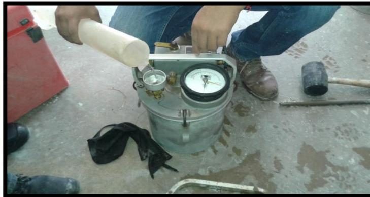
**FIGURA 3.21 Vertido de agua en equipo para determinar contenido de aire**
