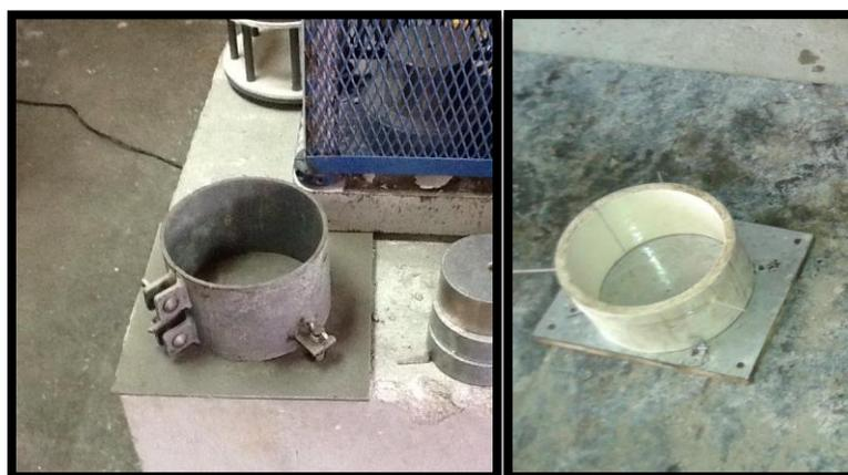
*FIGURA.3.15 Molde de hierro forjado y PVC de 20 x 12 cms de diámetro para especímenes de permeabilidad*
