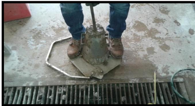
**FIGURA.3.18 Varillado para revenimiento**
