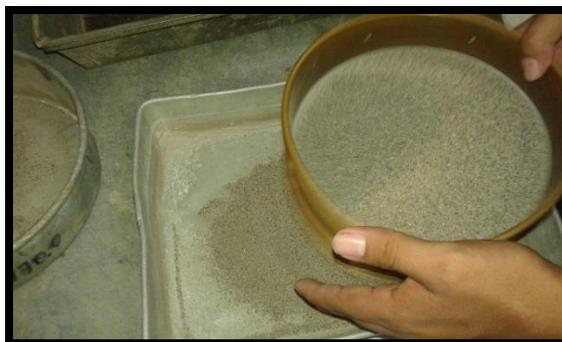
**FIGURA 3.6 Tamizado de agregado fino**
