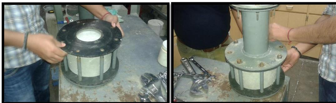
**FIGURA 3.37 Colocación de lámina de neopreno y parte superior del equipo**
