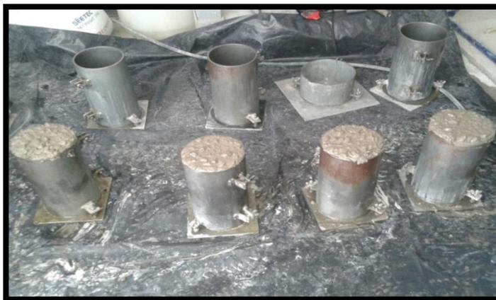
**FIGURA 3.25 Llenado de especímenes de 15 x 30 cms para ensayo a compresión**
