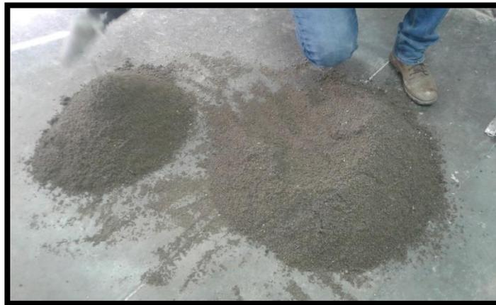
**FIGURA 3.4 Cuarteo agregado fina por apilamiento en miniatura**
