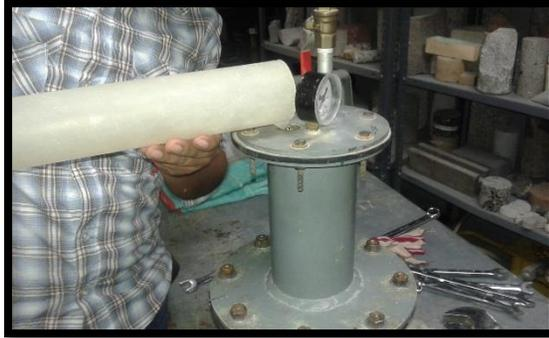
**FIGURA 3.38** Vertido de 200 ml de agua en el equipo
