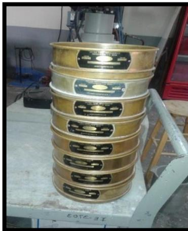
**FIGURA 3.5 Tamices certificados de abertura cuadrada para agregado fino**
