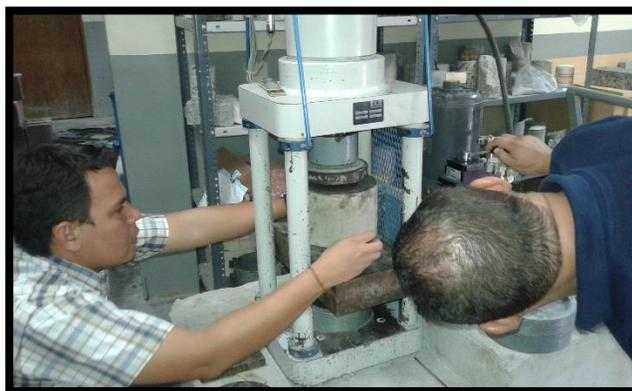
**FIGURA 3.41 Ajuste de muestra en máquina de compresión**
