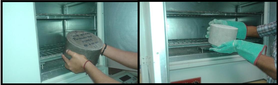
**FIGURA 3.34 Colocación y extracción de la muestra del horno**
