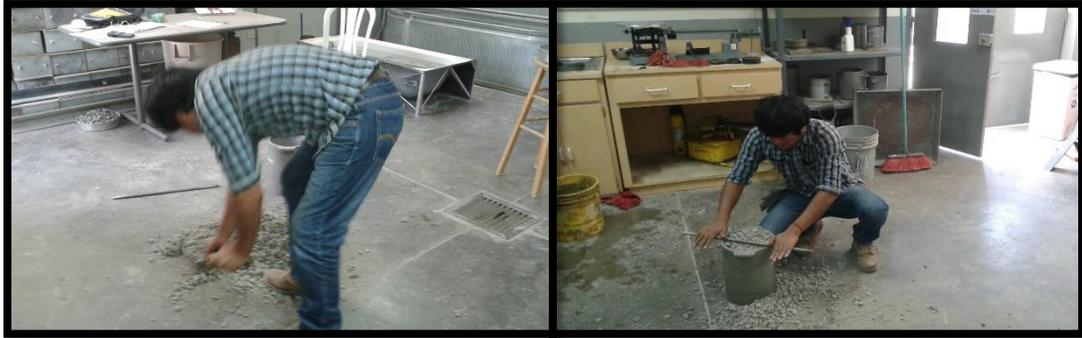
**FIGURA 3.9 Homogenizado de material para llenado de recipiente y enrazado para nivelar el material antes varillado**
