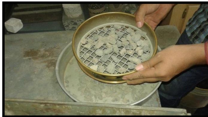
**FIGURA 3.8 Tamizado de agregado grueso**
