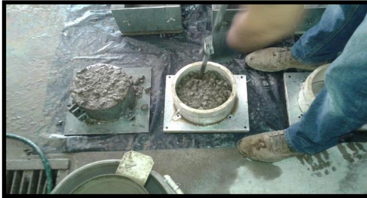
FIGURA 3.26 Varillado de cilindros para ensayo de permeabilidad
