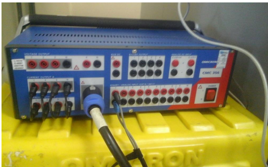
Figura 55: Unidad de pruebas de relés universal CMC 356
