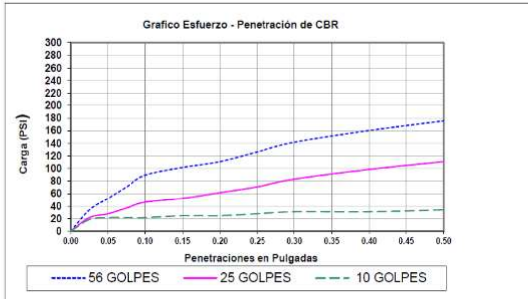
Grafico 6.15 Curva Esfuerzo- Deformación de CBR para PCA No 4.
