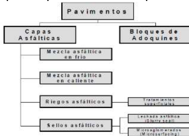
Figura 2.7 Tipos de superficie de rodadura en pavimentos flexibles.
