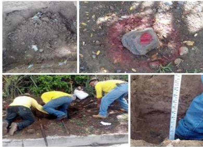
Imagen 5.0. Pozo Cielo Abierto # 1 en terreno natural.
