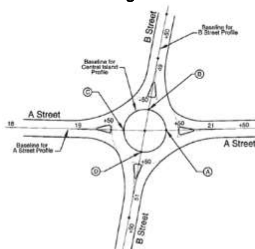
Figura 4.26 Perfiles generales de rotonda
